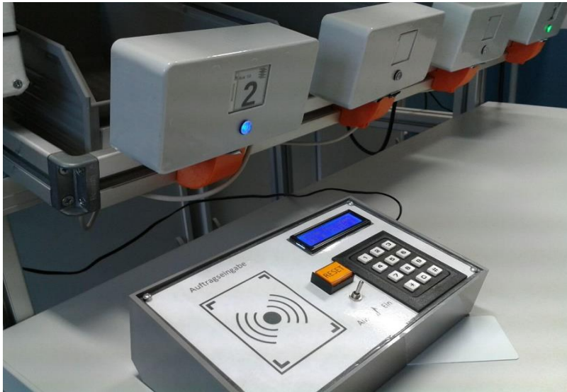
Abbildung 22 - PBL-System an der Hochschule für Angewandte Wissenschaften Hamburg, Karten- und Auftragsgerät, Juni 2018
