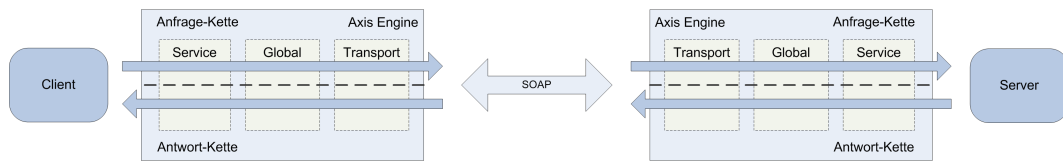
Abbildung 6.3.: Nachrichtenverarbeitung der Axis Engine
