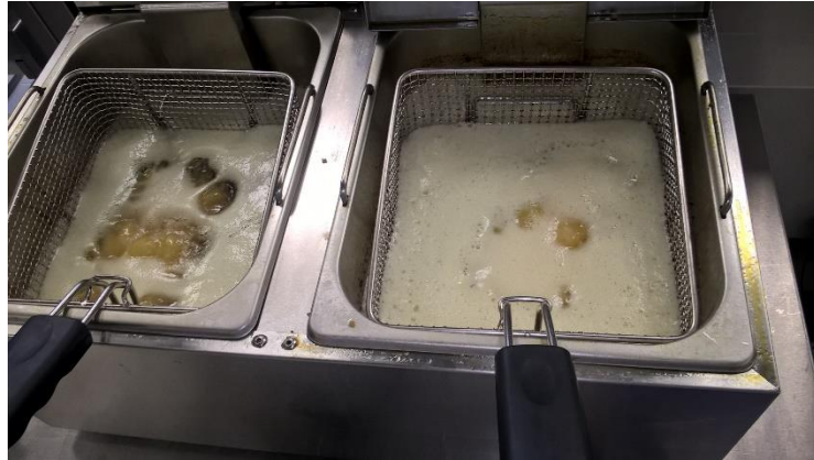
Abbildung 17: Vergleich der Schaumbildung zwischen gefiltertem Öl (links) und ungefiltertem Öl (rechts)
