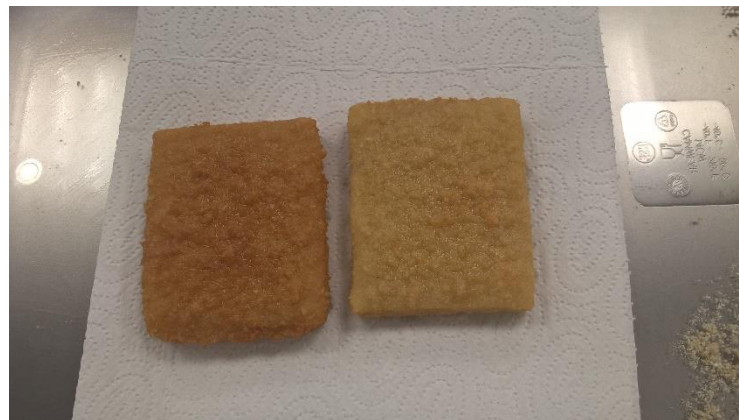
Abbildung 24: Farbunterschiede zwischen im KÖG frittierten Fisch-Patty(links) und im Referenz-Öl frittiertes Fisch-Patty am siebten Frittiertag
