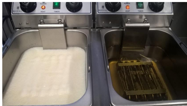
Abbildung 22: Schaumbildung nach dem ersten Einschalten im KÖG (links)
