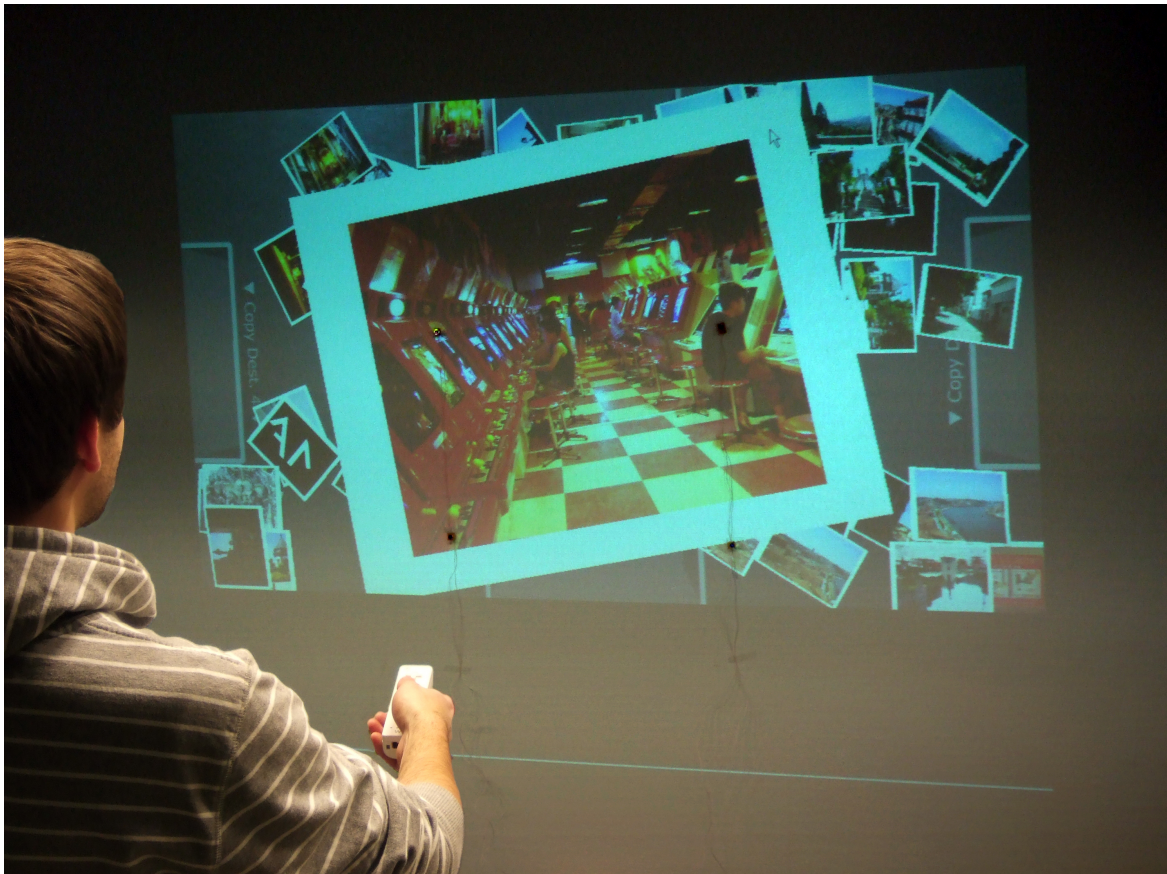
Abb. 4.23: Steuerung der DynAmbient-Software mit einer WiiMote-Fernbedienung.
