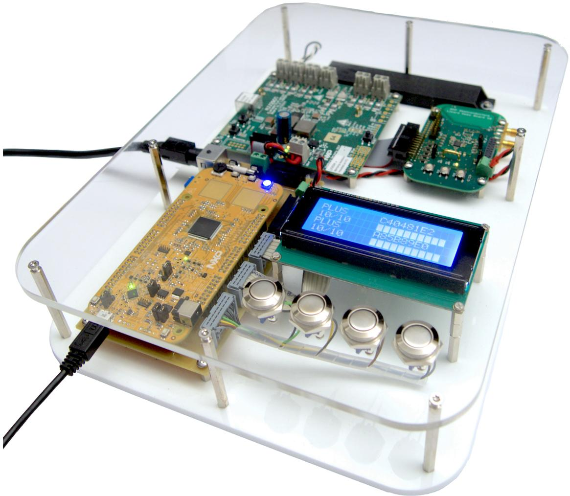
In dieser Abbildung ist das fertige Demo Board zu sehen, bei dem eine Messung durchgeführt wurde. Die Messwerte werden auf dem Display im PKE-Demonstrator Modus angezeigt. Die Demo ist auf der linken Seite über einen 12V-Anschluss gespeist. Das Kabel am S32K144 dient zur Kommunikation über UART.
