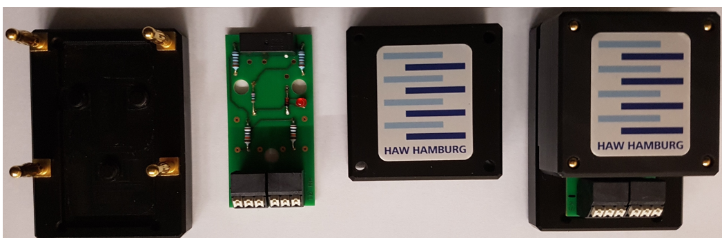
Abbildung 3.1.: Bauteile und Fertigprodukt, von links nach rechts: Unterbau, Platine (hier einpolig), Oberbau, Fertigprodukt
