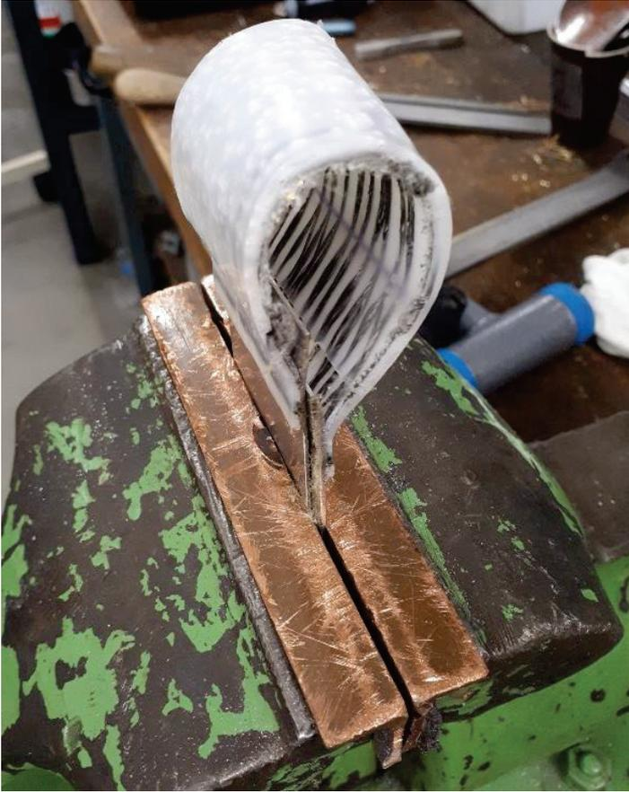
Abbildung 79 In Spannbacken eingespannte Probe V03.1 VI während des Erhaltens
