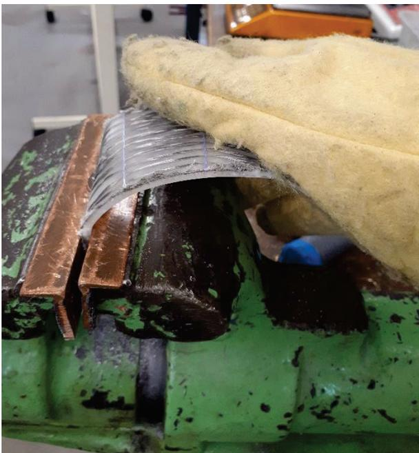
Abbildung 74 Händische Umformung am Schraubstock
