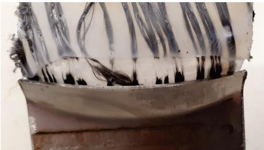
Abbildung 69 Umgeformte Probe mit gerissenen Fäden
