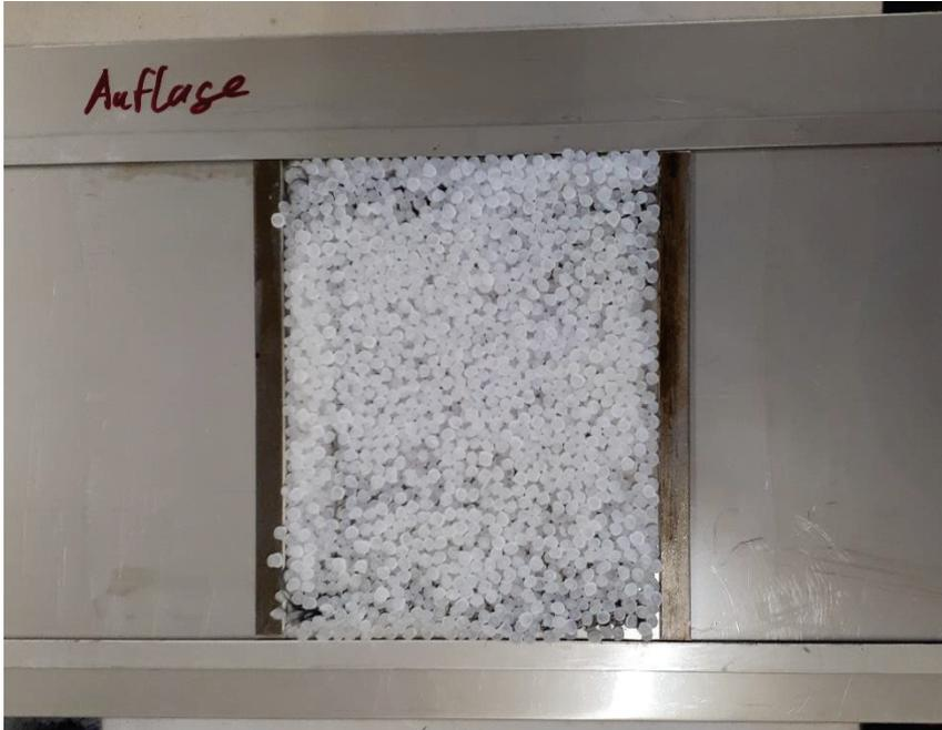
Abbildung 35 Aufbau Vorversuch 3 mit Gewirk mit Granulat
