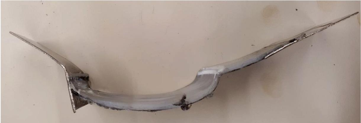
Abbildung 95 Umgeformte Probe mit deutlich verschobenem Zugbereich
