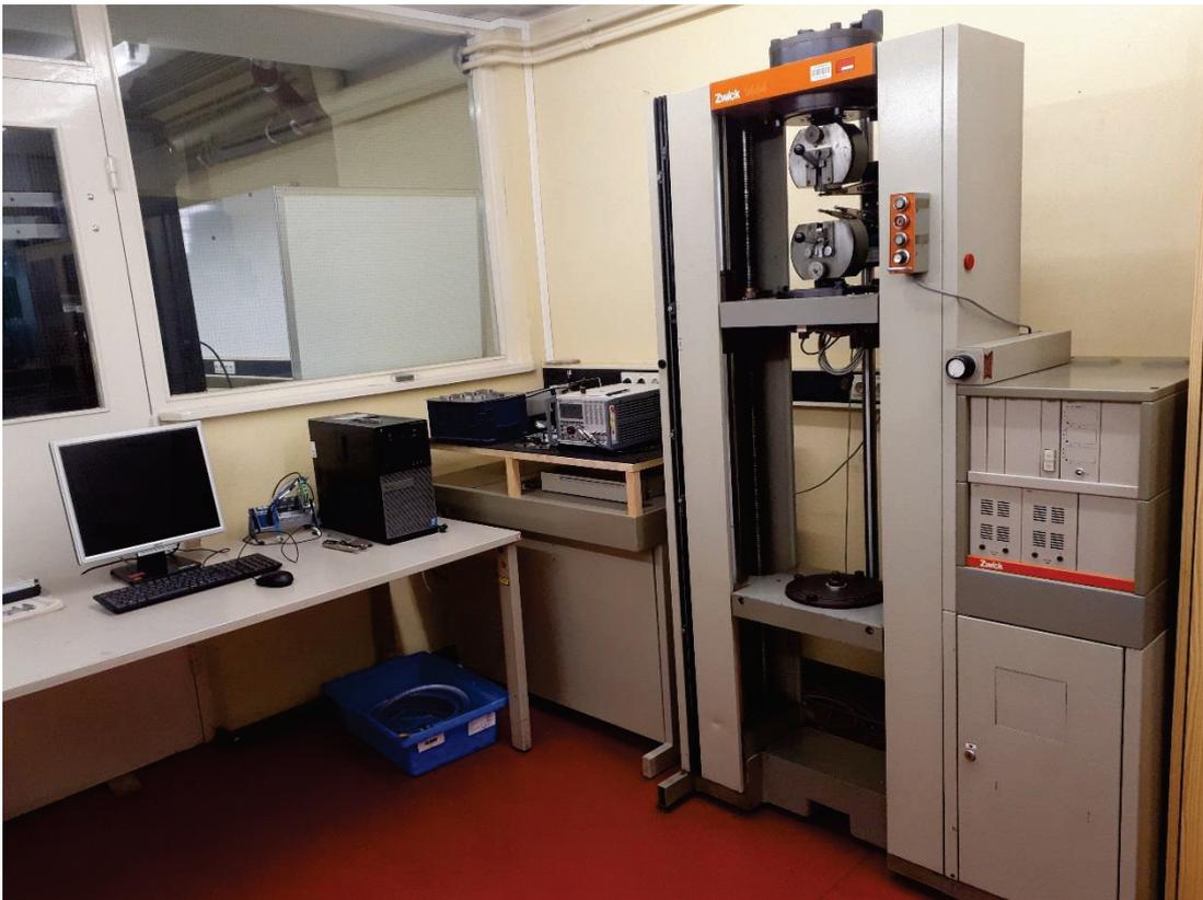
Abbildung 60 Zwick Zugmaschine mit angeschlossenen Systemen
