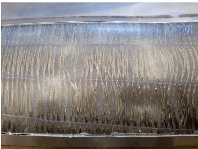
Abbildung 42 Detailansicht Fasereinbettung bei Paneel aus Vorversuch 4
