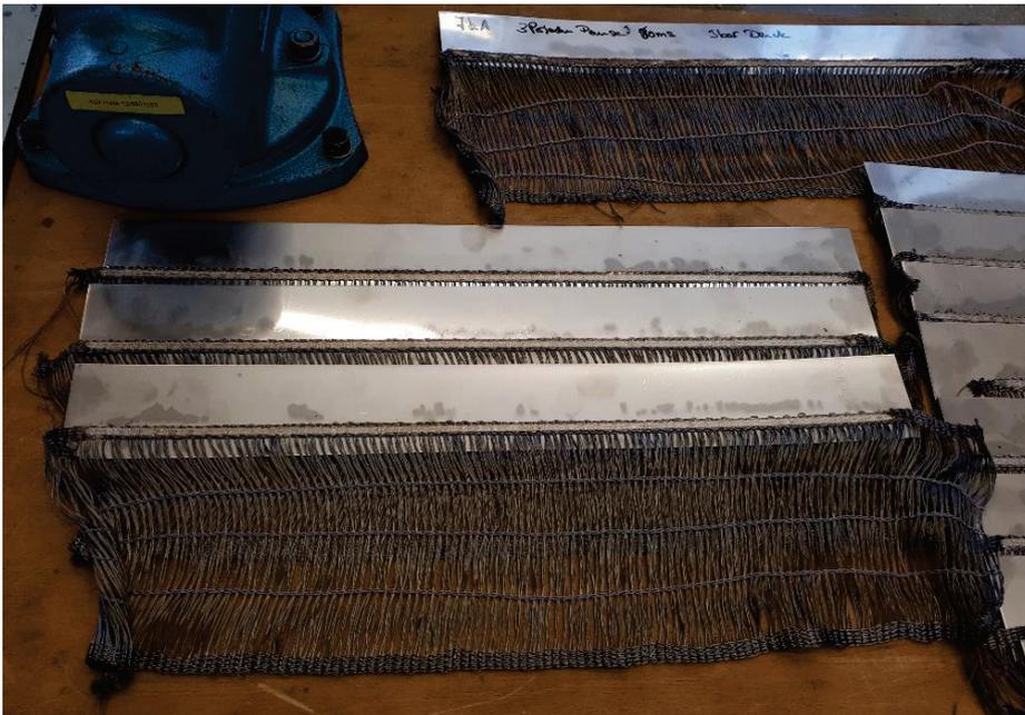
Abbildung 20 Halbseitig geschweißte Elemente aus Blech und Gewirk
