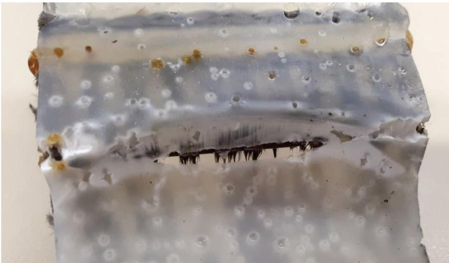
Abbildung 68 Während der Umformung am Blech abgescherte Probe
