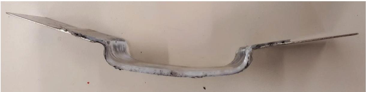
Abbildung 91 Umgeformte Probe erkaltet im Werkzeug
