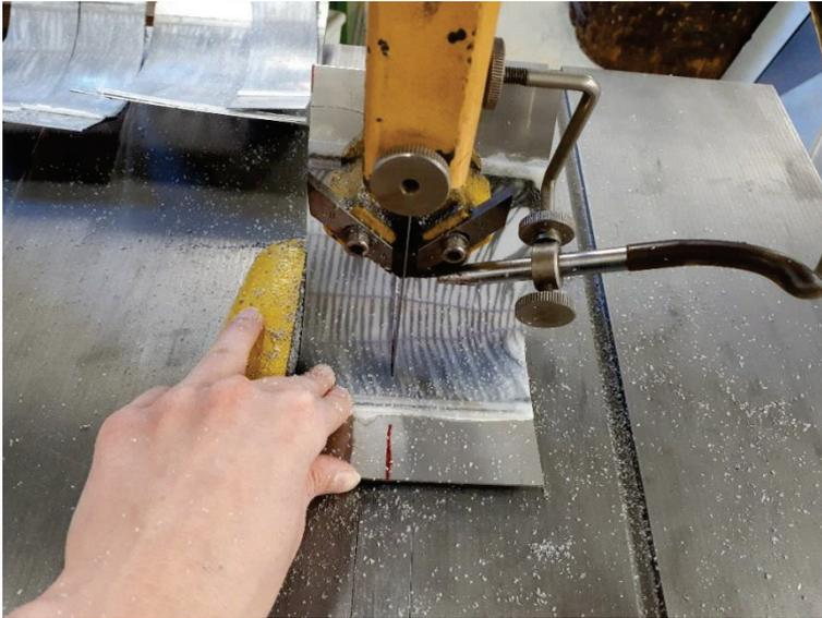
Abbildung 57 Zersägen der Paneele zu Probenkörpern
