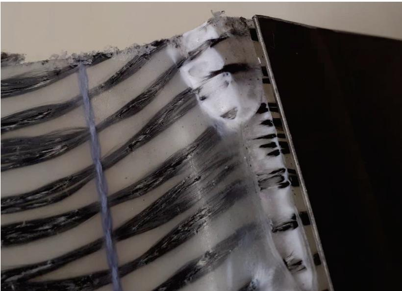
Abbildung 72 Umgeformte Probe mit Rissen sowie geringen Fließen des Kunststoff
