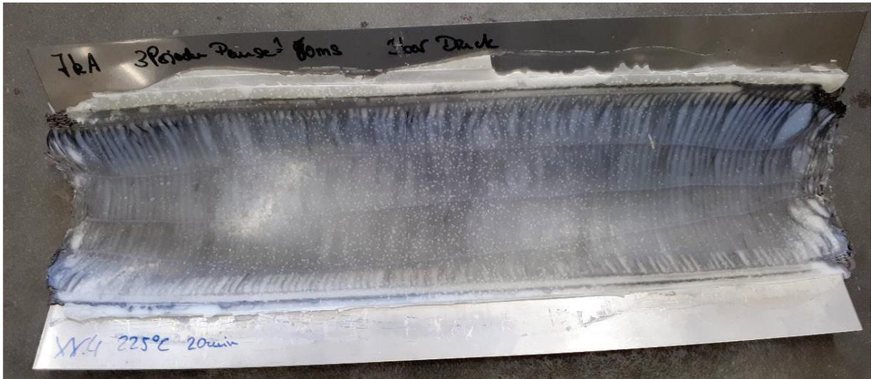
Abbildung 40 Laminiertes Paneel aus Vorversuch 4 (Draufsicht)
