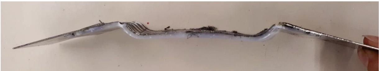
Abbildung 92 Umgeformte Probe mit Gewirk oben
