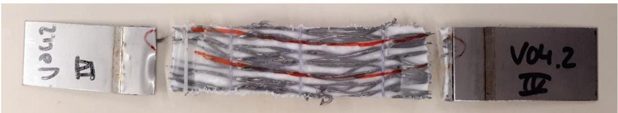
Abbildung 62 Bei Umformung zerbrochene Probe V04.2 IV in Draufsicht
