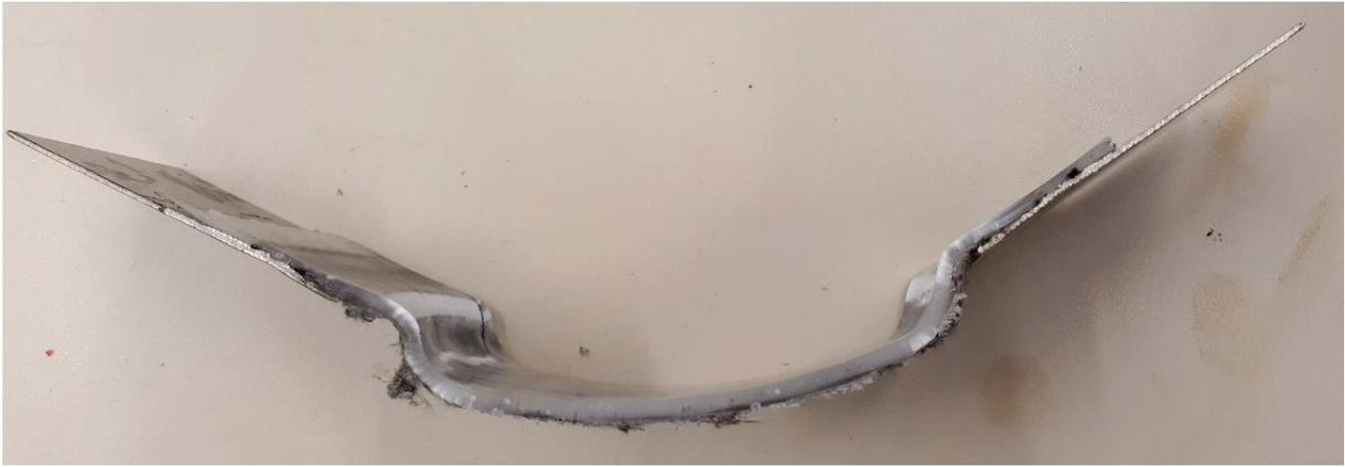
Abbildung 90 Umgeformte Probe erkaltet an Luft
