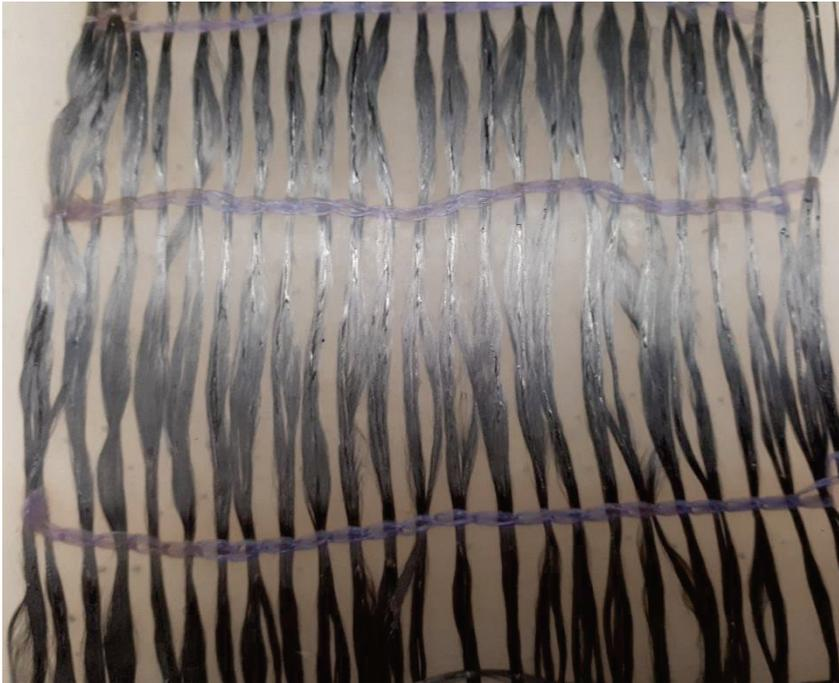
Abbildung 39 Detailansicht Fasereinbettung bei Laminat aus Vorversuch 3
