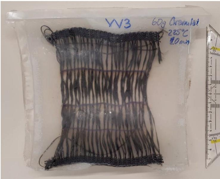
Abbildung 36 Laminat mit Gewirk aus Vorversuch 3 (Draufsicht)
