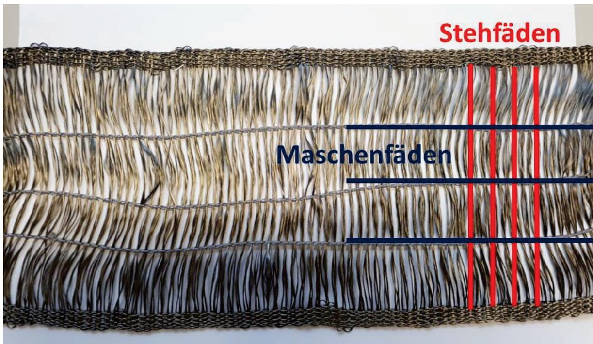
Abbildung 17 Stahlgewirk mit Steh- und Maschenfäden
