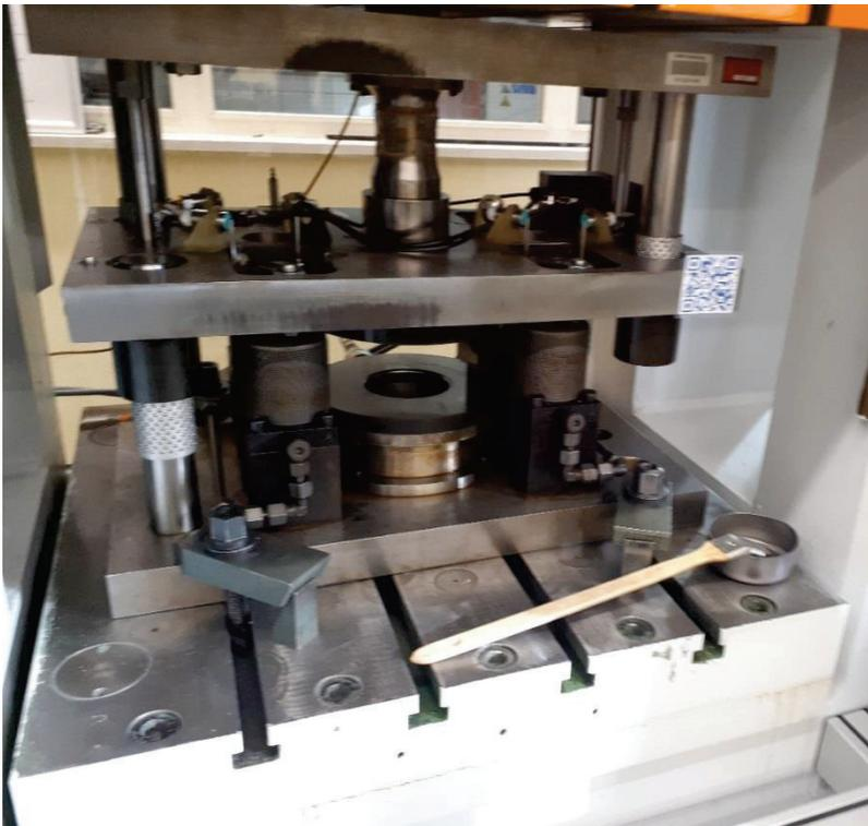
Abbildung 59 Werkzeug mit Stempel der Hydraulikpresse
