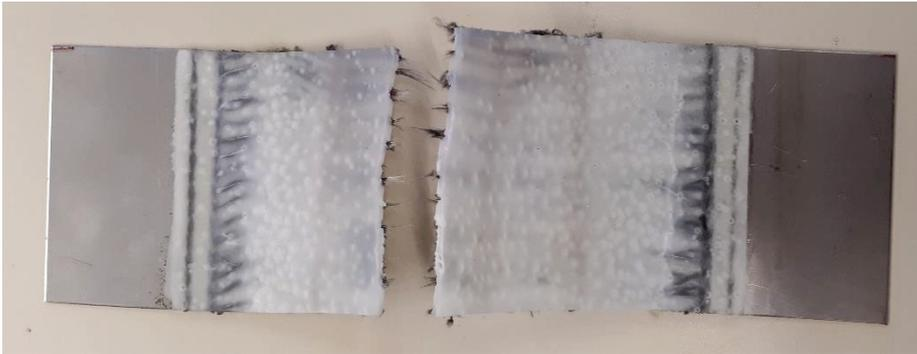
Abbildung 75 Spröde gebrochene Probe V05.1 VII nach händischer Verformung
