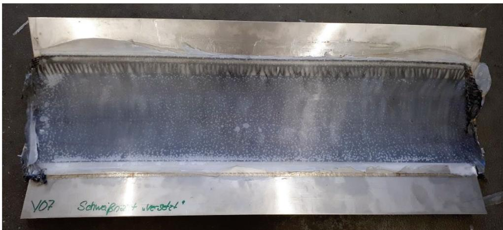
Abbildung 87 Unsauberes, entformtes Laminat
