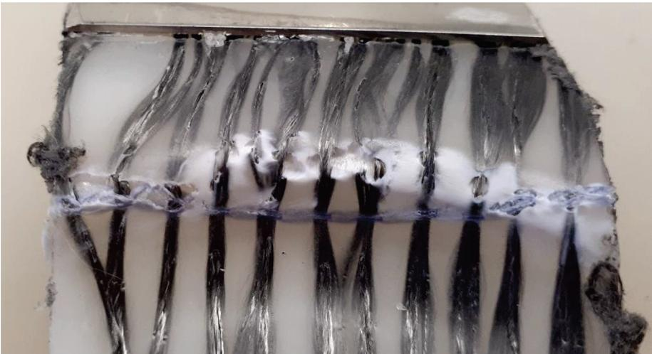
Abbildung 71 Umgeformte Probe mit Weißbruch und Rissen
