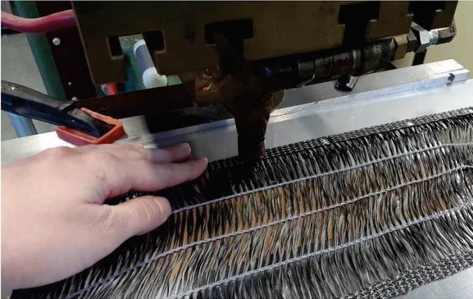
Abbildung 21 Punktschweißen von Gewirk mit Blech
