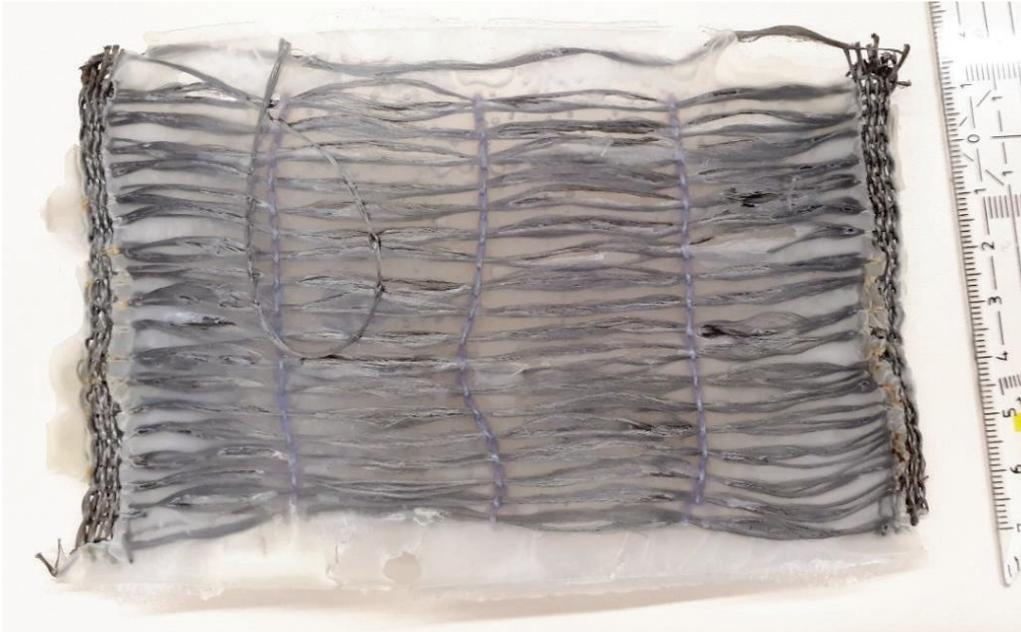
Abbildung 34 Laminat mit Gewirk aus Vorversuch 2 (Bodenansicht)
