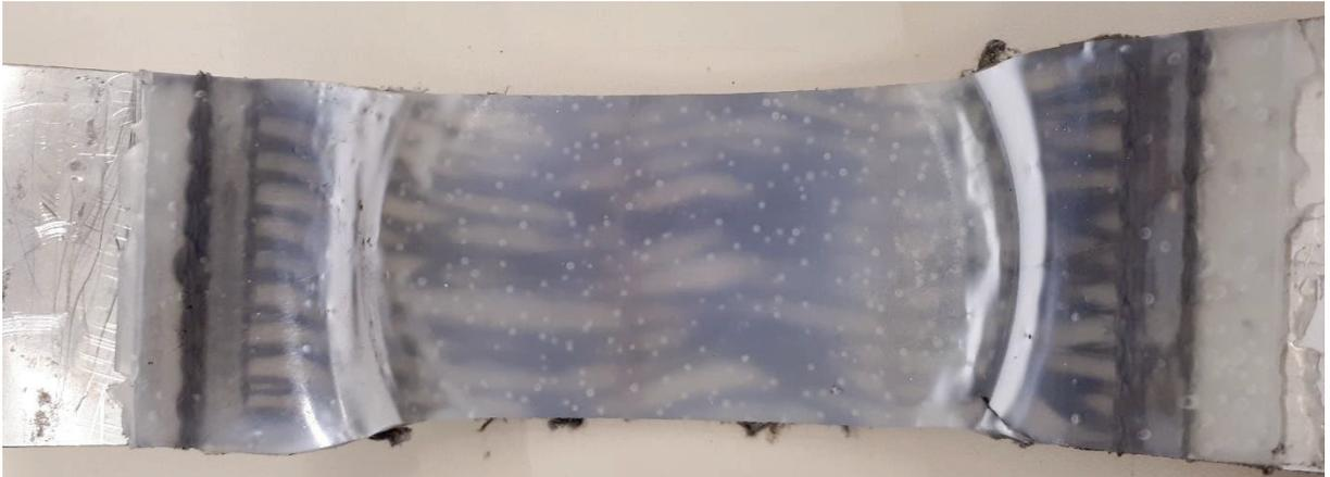
Abbildung 67 Umgeformte Probe mit Weißbruch
