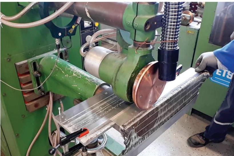
Abbildung 22 Widerstandsrollennahtschweißen von MeTHa
