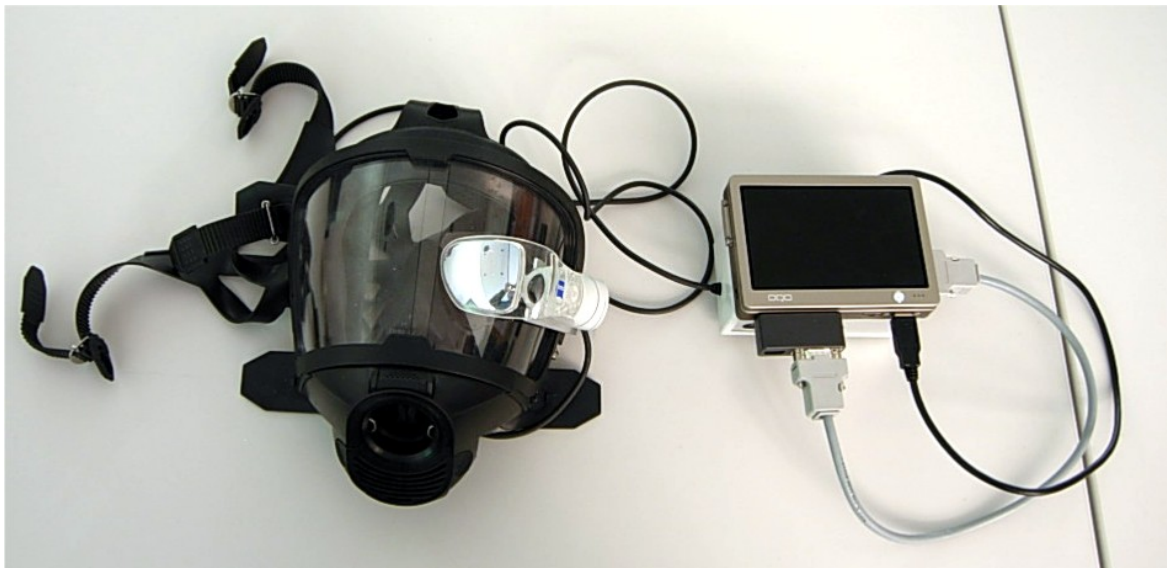
Abbildung 5.10: Wearable Prototyp bestehend aus Zeiss Head-Mounted Display, Atemschutzmaske und OQO-Computer
