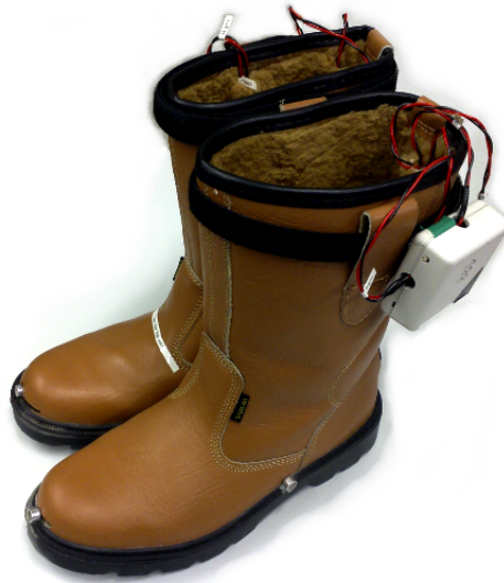
Abbildung 5.12: Stiefel mit integrierten LifeNet-Beacons
