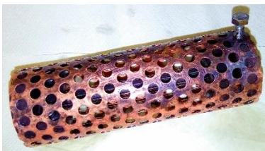
Abbildung 9 Benutztes Passivsammlergestell aus Kupfer (Stefan Rössel)
