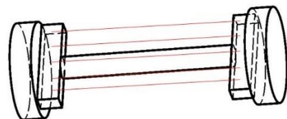
Abbildung 11 Schematische Zeichnung der Haltevorrichtung für die Fasern (rot). Innenansicht des Sammlers (Stefan Rössel)
