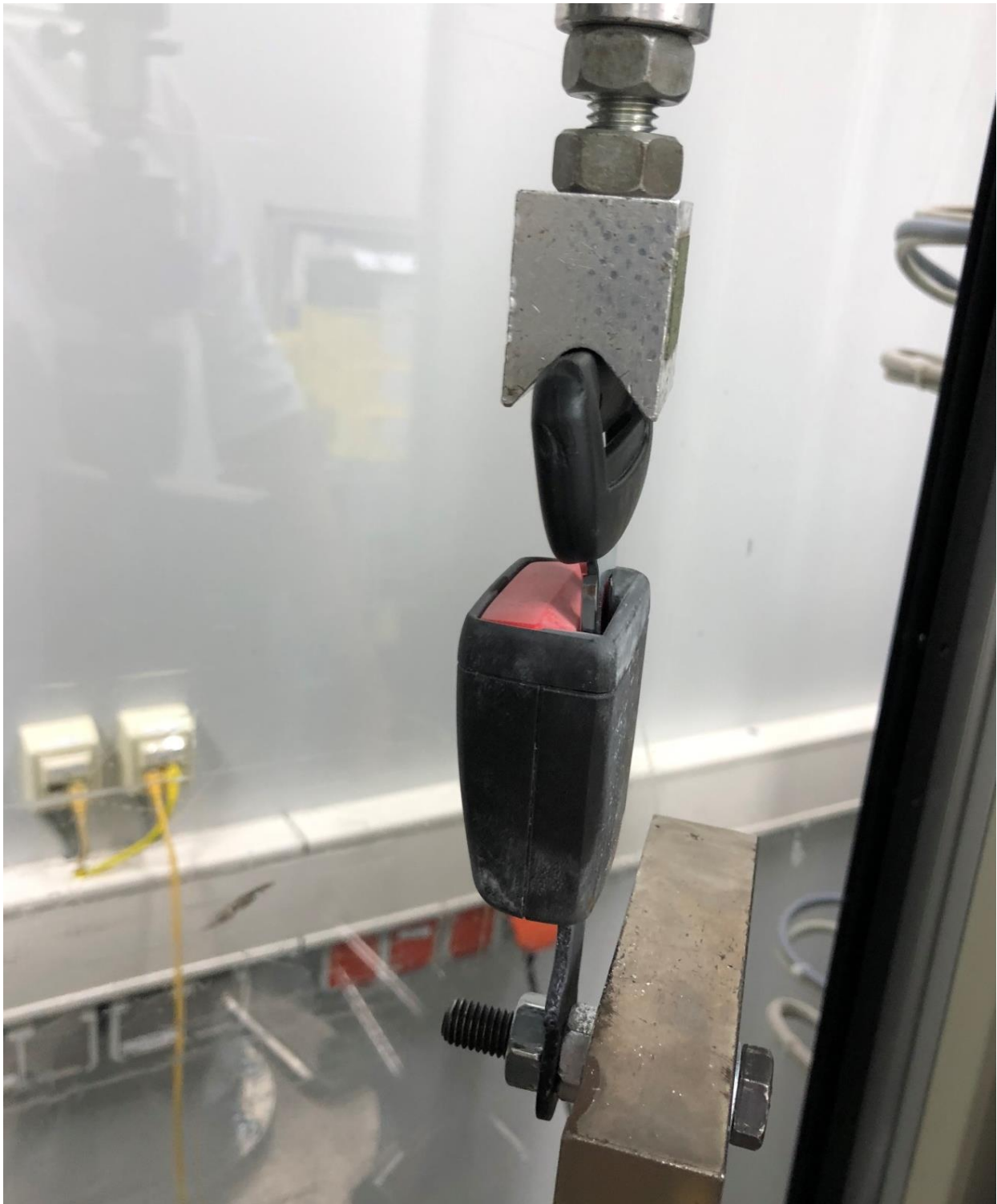
Abbildung 4.16: Aufbau der Einsteckkraftmessung mit gealtertem Schloss.
