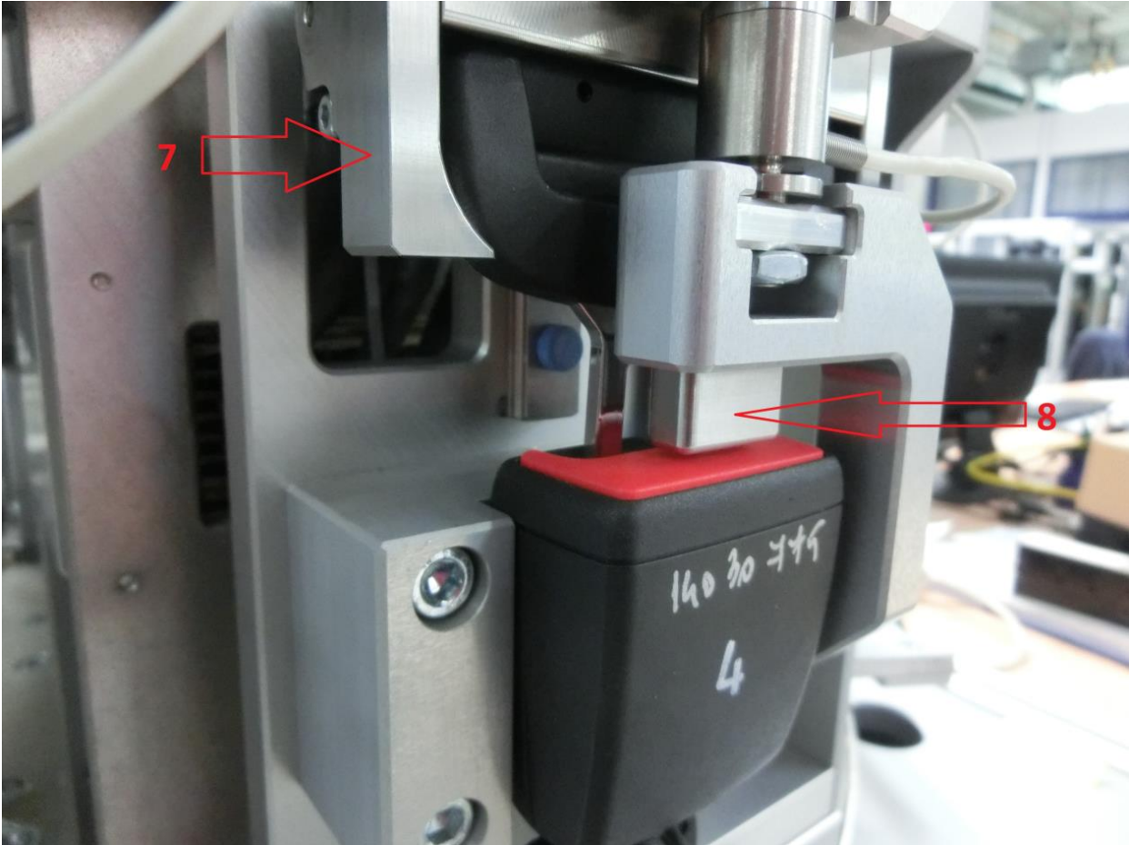
Abbildung 3.7: Detailansicht der beweglichen Teile (Zungennest und Drücker)
