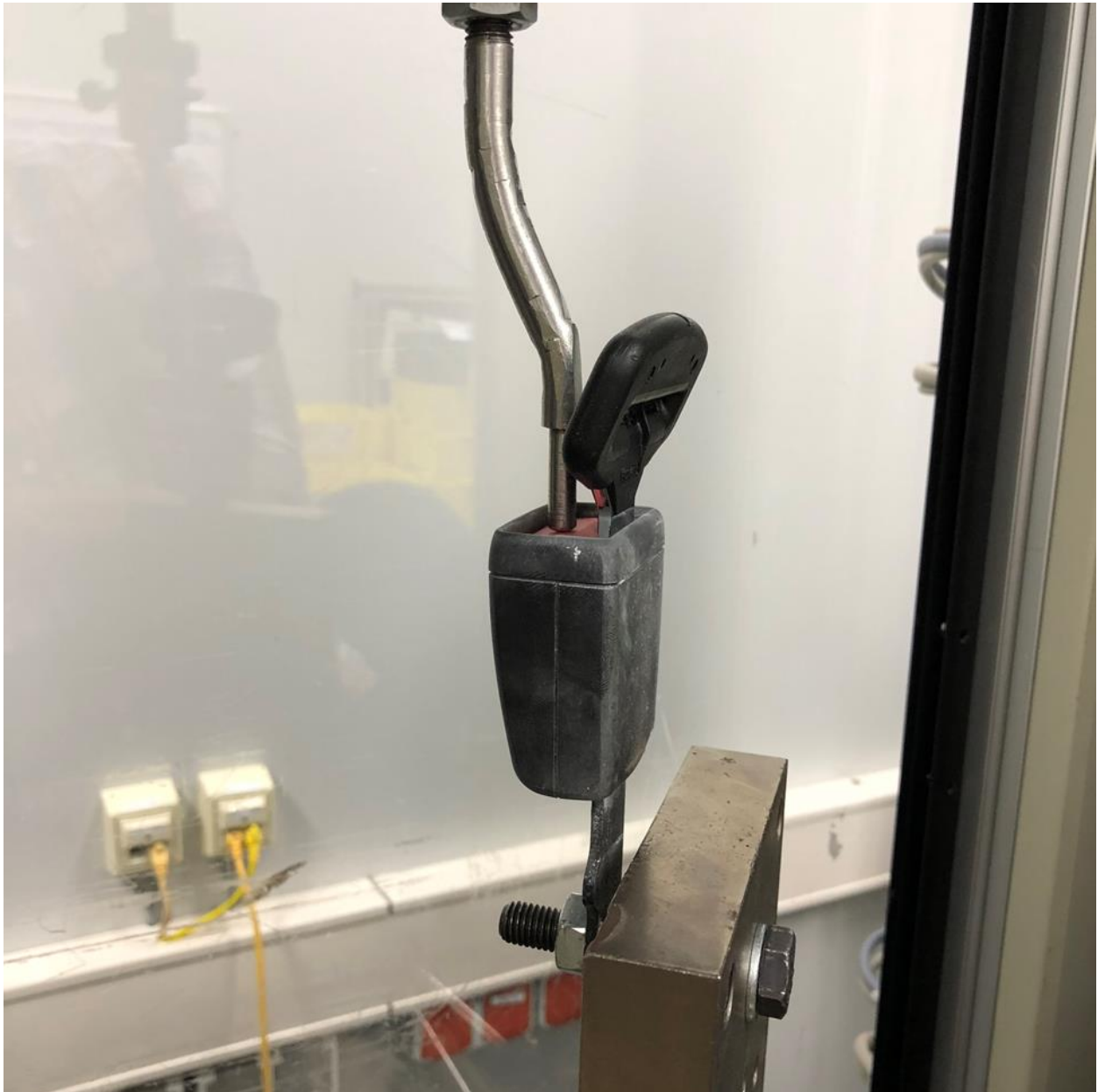
Abbildung 4.15: Aufbau der Schlossöffnungskraftmessung mit gealtertem Schloss.
