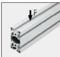
Die Profile sollten möglichst hochkant zur erwarteten Belastung eingebaut werden, um so die größtmögliche Biegesteifigkeit zu erzielen.
