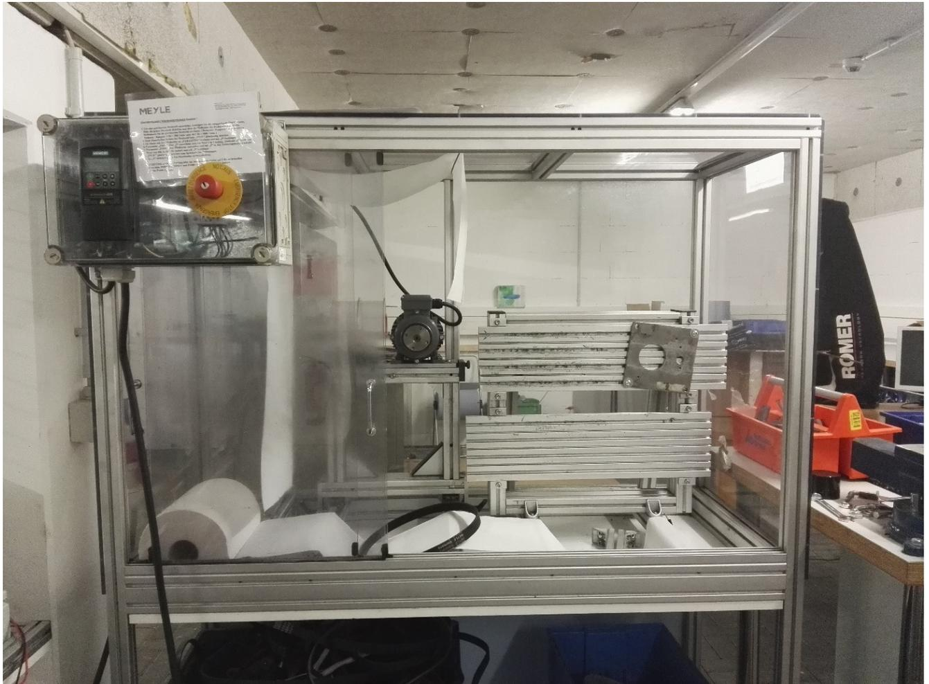
Abbildung 26 Radlagerprüfstand der MEYLE AG (eigene Darstellung)
