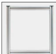
Nach Möglichkeit sollten die senkrechten Profile über die gesamte Länge durchlaufen. Dadurch vereinfacht sich die Anbindung der Bodenelemente und es entsteht ein besserer optischer Gesamteindruck.
