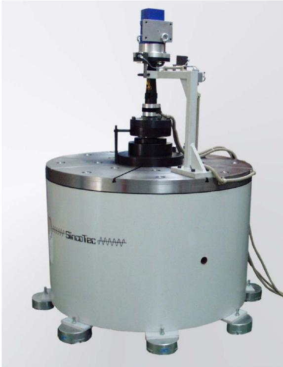
Abbildung 21 Radlagerprüfstand der Firma SinoTec [18]
