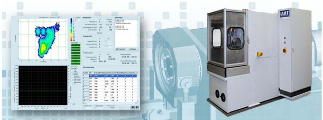
Abbildung 23 Radlagerprüfstand der Firma IAMT Prüfsysteme GmbH [25]
