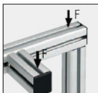
Alle Konstruktionen sollten belastungsgerecht ausgeführt werden, d. h. dass eine Verdrehbeanspruchung in den Verbindungsstellen vermieden wird und der Formschluss gegenüber dem Reibschluss in Kraftrichtung bei allen Verbindungen bevorzugt werden sollte.
