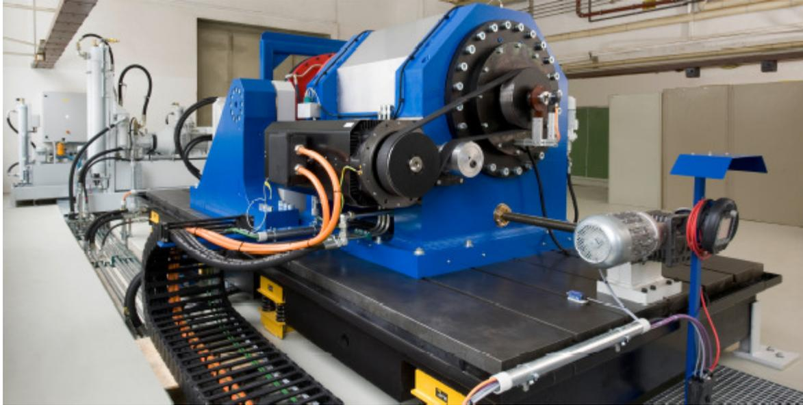
Abbildung 25 Großwälzlagerprüfstand der IMKT Universität-Hannover [28]
