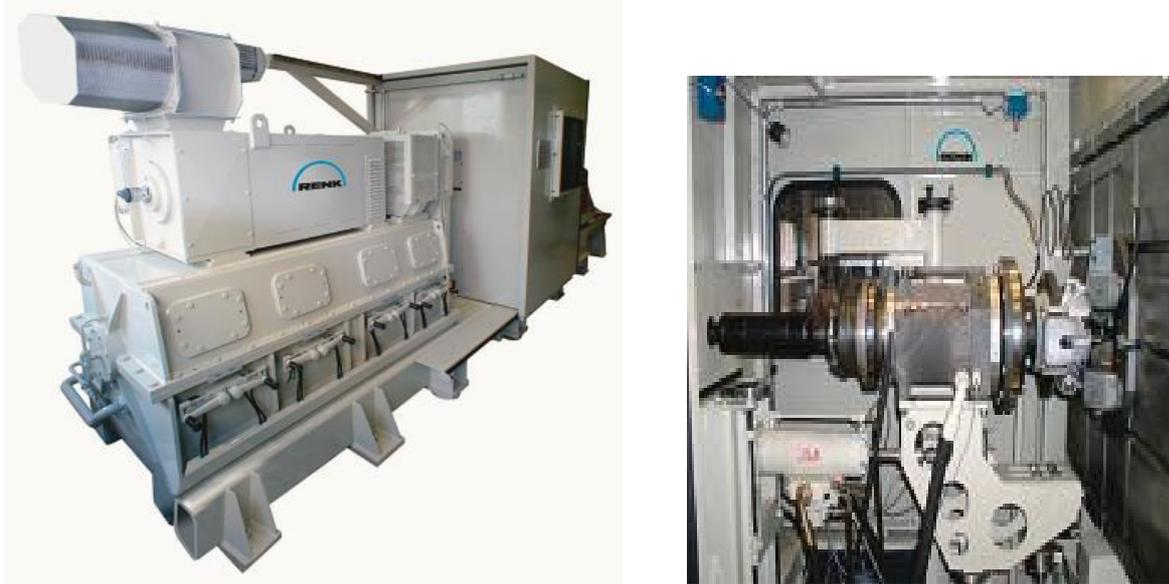
Abbildung 22 Radlagerprüfstand der Firma Renk Test System GmbH [24]
