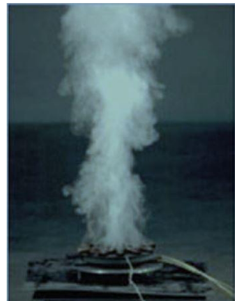
Abbildung 10. Pyrolyseschwelbrand nach DIN EN 54, Anhang B [14].
