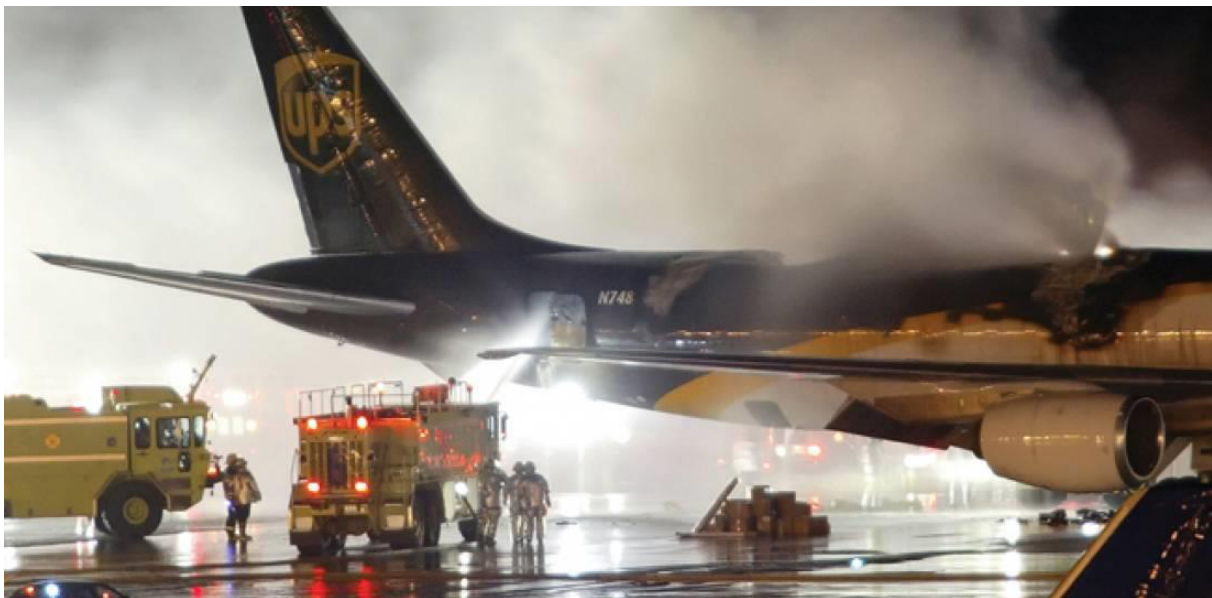
Abbildung 1. Feuer im Main-Deck-Frachtraum einer B747-400F von UPS[2].
