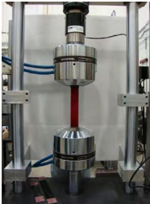
Abbildung 3-1: Eingespanntes Gurtelement zur Zugprobe [33]
