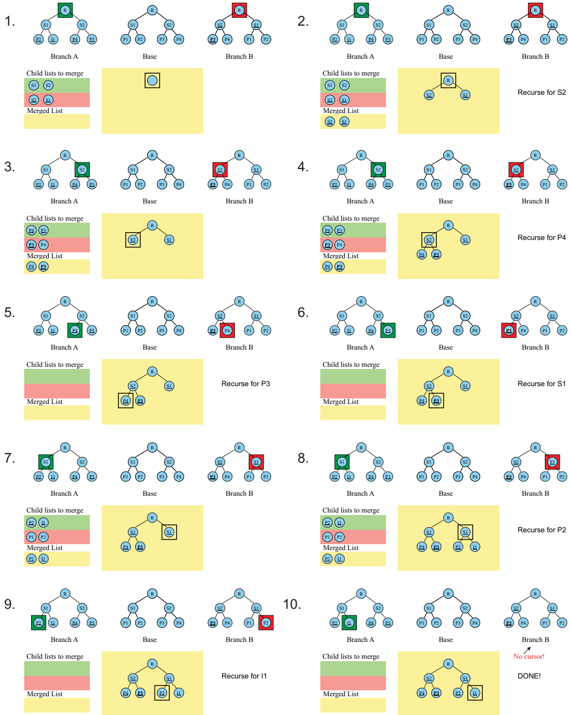
Abbildung 2.8.: Illustration des Merge-Algorithmus [Lin01, S.78]
