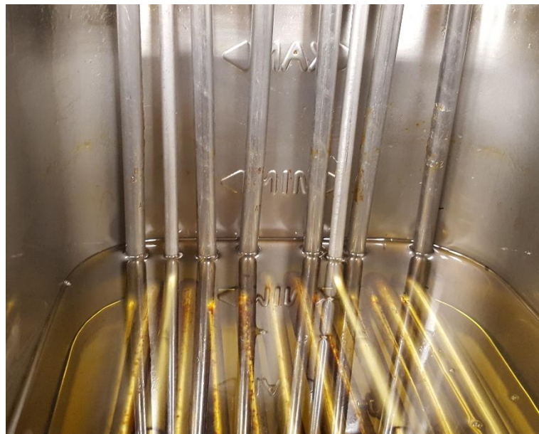
Abbildung 21: Befüllung mit der Mindestfüllmenge laut Herstellerangabe von 6,5 l Öl, was unterhalb der Minimal-Markierung des Füllbeckens liegt
