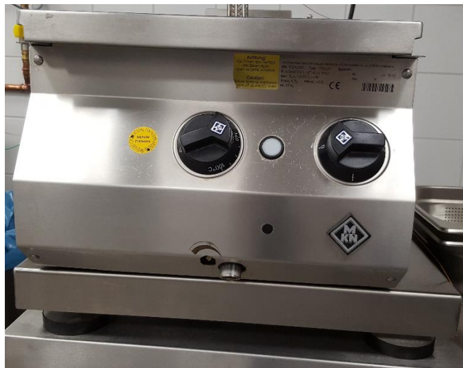
Abbildung 7: Bedienelemente und Fettablauf der Fritteuse London I von MKN
