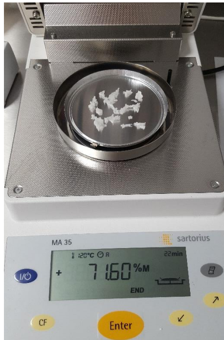
Abbildung 25: Ergebnis der Probe eines tiefgekühlten SW-Stäbchens mit einem Wasseranteil von 71,60 %
