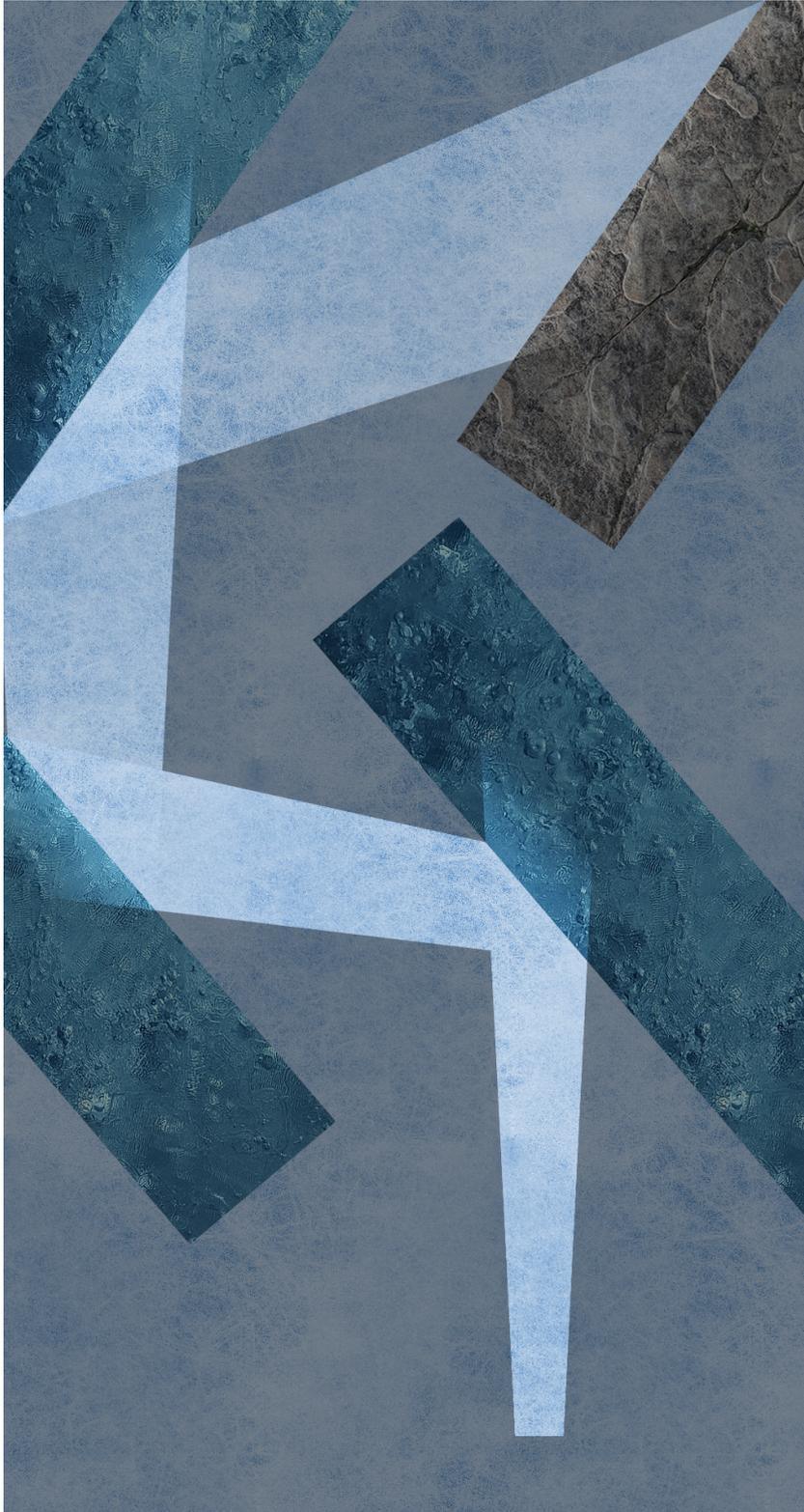
Abbildung A.16: Szene mit rein gerichteten Reflexionen. Lichtstrahl wird zwischen den ersten 3 Wänden reflektiert und an der vierten absorbiert. Raytracing der Szene 11 m s, Rastern der Lightmap: 4 m s, Gesamt 15 m s
