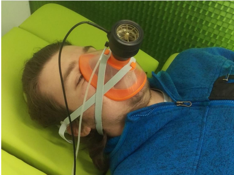
Abbildung 3-2: Atemmaske mit Volumenstrom- und Gassensor
