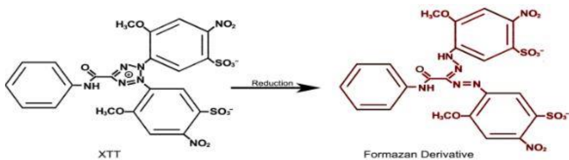
Abbildung 1.3 Reduktion von XTT zu seinem Formazansalz
