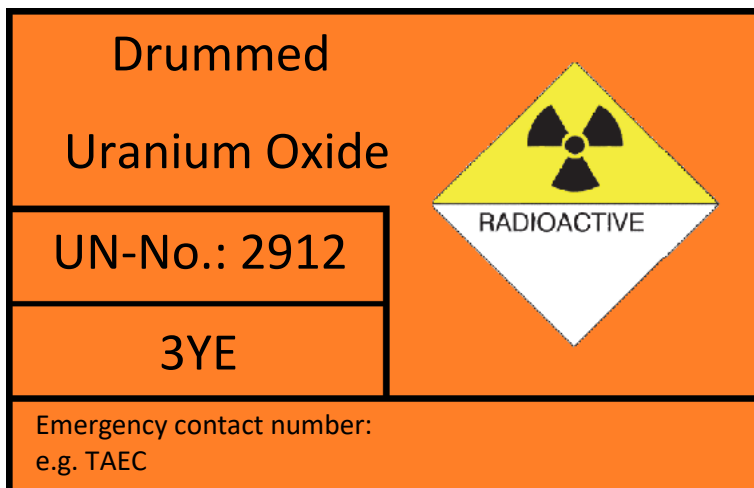
Abbildung 4: Beispielentwurf eines theoretisch möglichen HazChem Code Labels für Uranoxidkonzentrat auf Grundlage der Aussagen der TPA [8, pp. 5-22].
