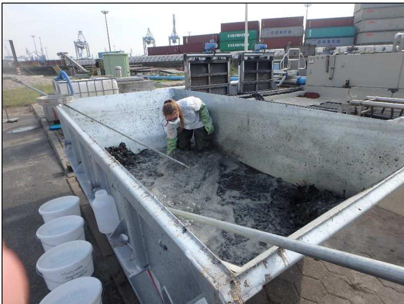
Abbildung 16: Probenahme der Mischproben mit Durchmischung durch Lufteintrag
