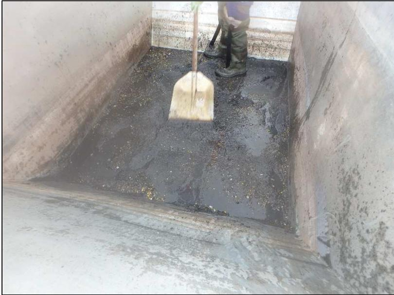
Abbildung 17: Probenahme der Mischproben mit Durchmischung mit einer Schaufel
