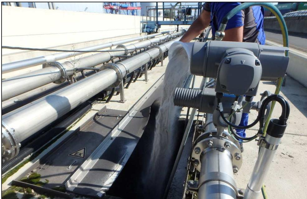
Abbildung 9: Prüfsandzugabe mit Lufteintrag am Zulauf des Sandfangs
