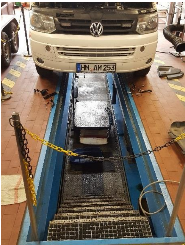
Abbildung 17: Montagegrube in der Kfz-Werkstatt (Quelle: eigene Darstellung)
