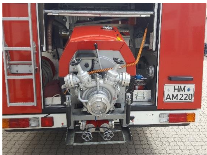
Abbildung 18: Tragkraftspritze in der Fahrzeughalterung (Quelle: eigene Darstellung)
