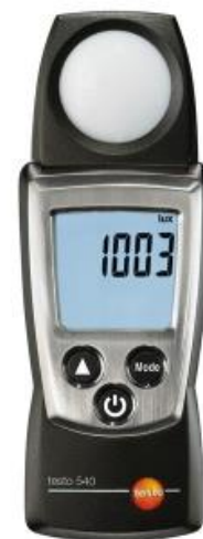
Abbildung 7: Luxmeter testo 540 (Quelle: testo SE & Co. KGaA)
