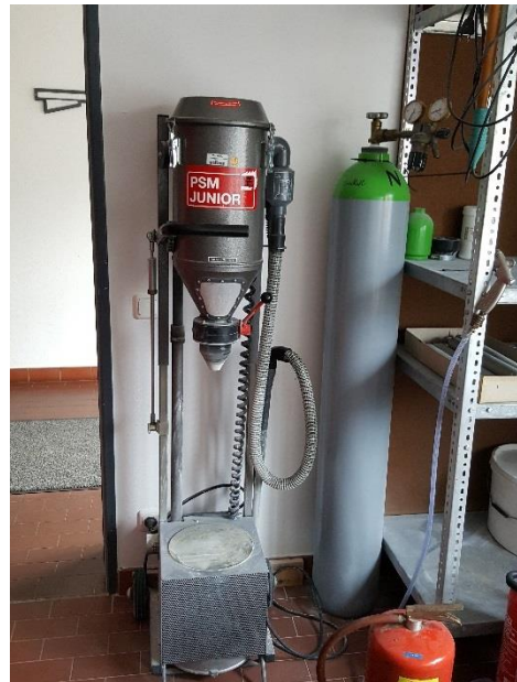
Abbildung 19: Vorrichtung zur Befüllung der Feuerlöscher (Quelle: eigene Darstellung)
