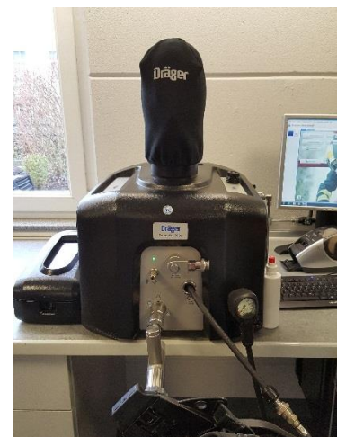
Abbildung 29: Druckluftprüfanlage für Atemschutzmasken (Quelle: eigene Darstellung)
