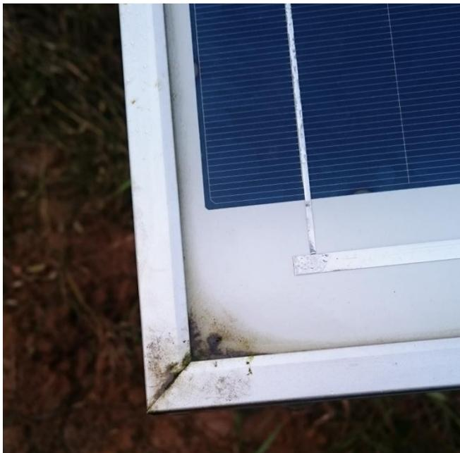
**Bild 5.1** Verschmutzung bei X-Modulausrichtung im Dezember 2016
