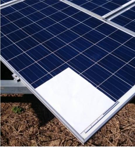
**Bild 3.12** Verschattung eines Modules mit DIN A3 Papier
