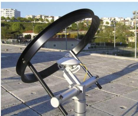
**Bild 2.8** Pyranometer mit Schattenring (RG Messtechnik o. J.)
