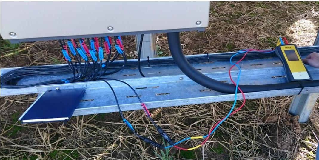
**Bild 3.13** Kennlinienmessung mit *TRI-KA* Messgerät
