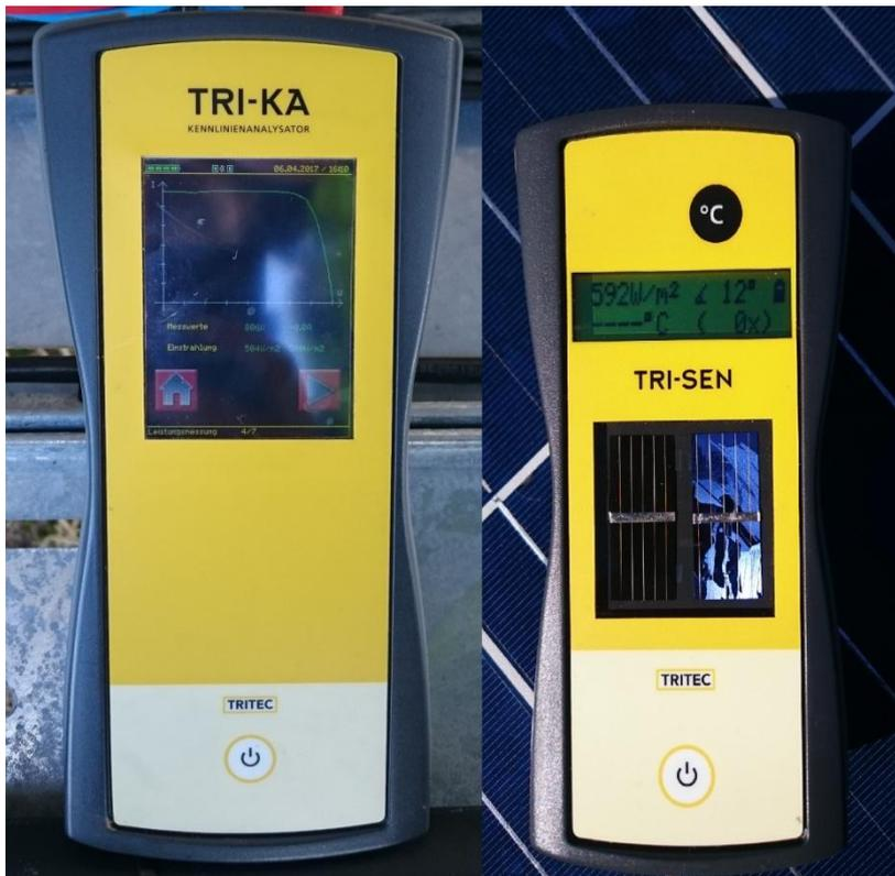
**Bild 3.11** *TRI-KA* (links) und *TRI-SEN* (rechts) Messgeräte
