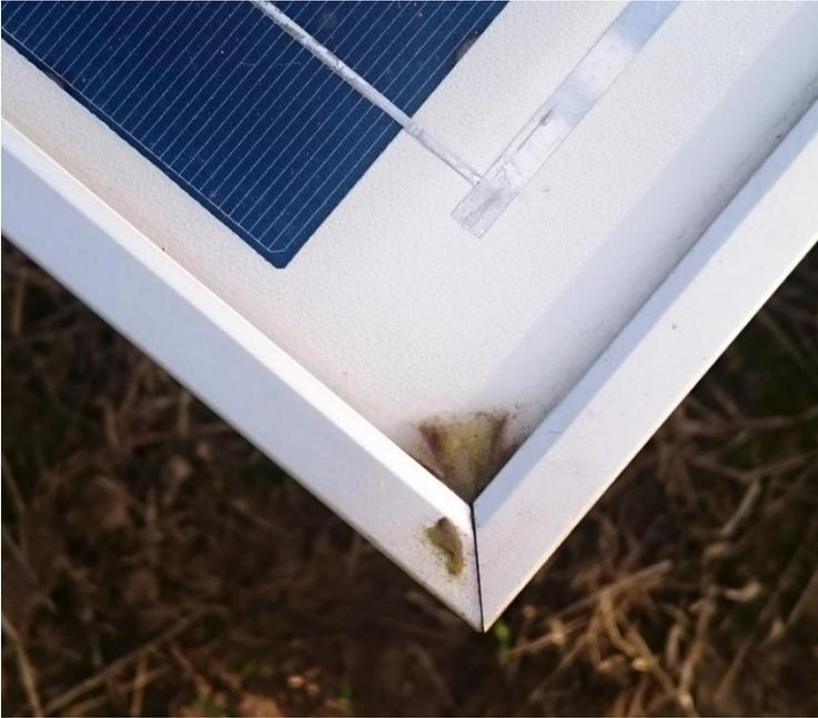
**Bild 5.2** Verschmutzung bei X-Modulausrichtung im April 2017
