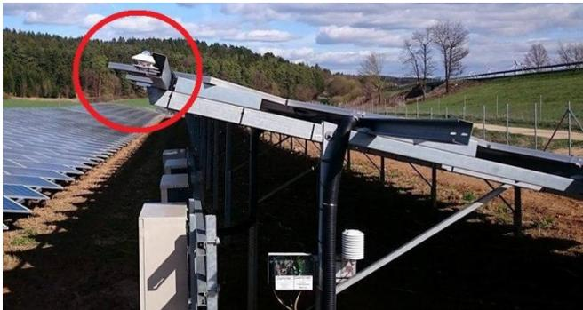
**Bild 2.7** Pyranometer in Modulebene
