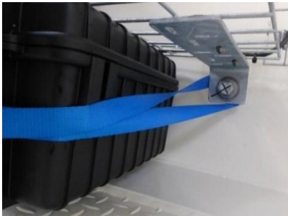
Abbildung 6-3: Anschweißbolzen als Anschlagpunkte für die Spanngurte (RECASE - Regenerative Energien GmbH, 2017, p. 7)
