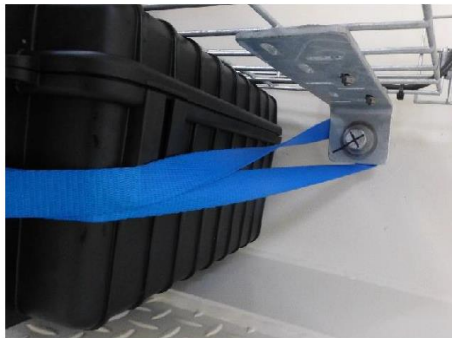
Abbildung 4-4: Befestigung an dem Anschweißbolzen
