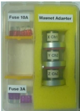
Abbildung 5-6: Box mit den Magnetadaptern und den zusätzlichen Sicherungen (RECASE - Regenerative Energien GmbH, 2017, p. 8)
