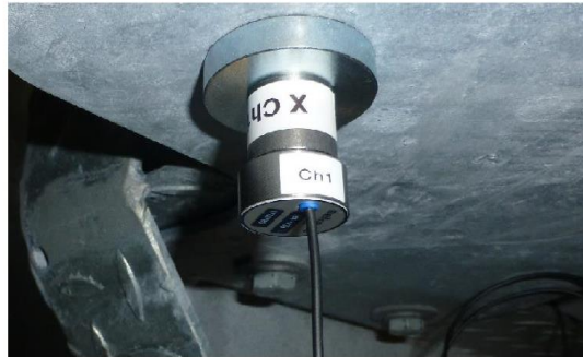
Abbildung 5-7: Beispiel für die Kombination von Adapter und Sensor für die X-Richtung (Ch1)
