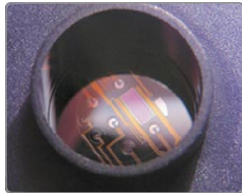
Abb. 3: Ein Mikrochip aus Silizium der Firma Micronas. Der Chip besitzt Sensoren für die Messung der Impedanz, des pH-Wertes und der Sauerstoffkonzentration im Medium. Bionas http://www.bionas-discovery.com/prodservices/ .
