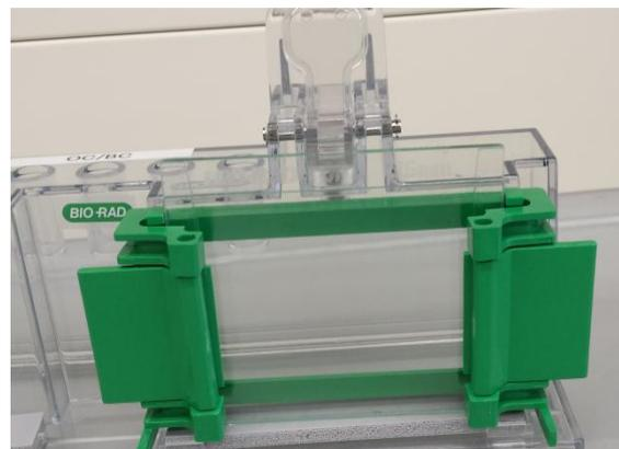
Abbildung 2: Halterung zum Gießen der Gele
