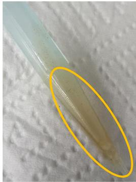
Abb. 12: Stark benetzte Pipettenspitze
