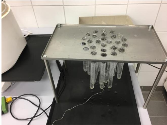
*Abbildung 3: Halterungsvorrichtung bestückt mit Reagenzgläsern von oben*
