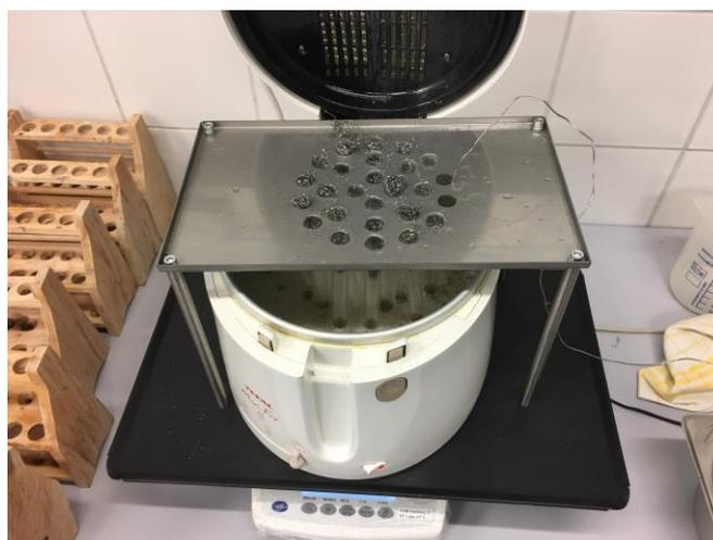
Abbildung 9: Verdampferkonstrukt aus Reagenzgläsern und Fritteuse "Maxi Fry" von oben
