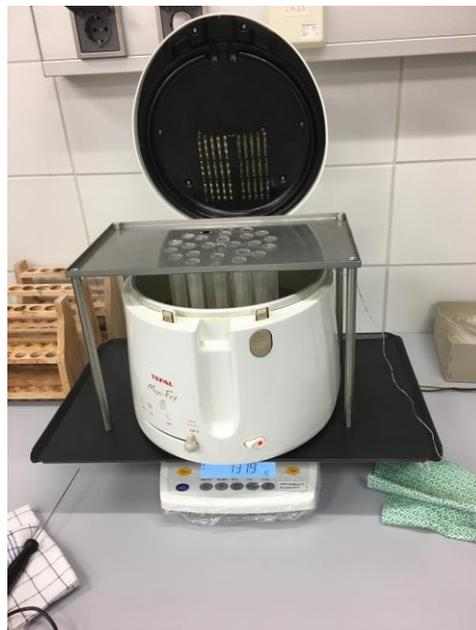
*Abbildung 4: Aufbau Verdampferkonstrukt aus Reagenzgläsern und Fritteuse*
