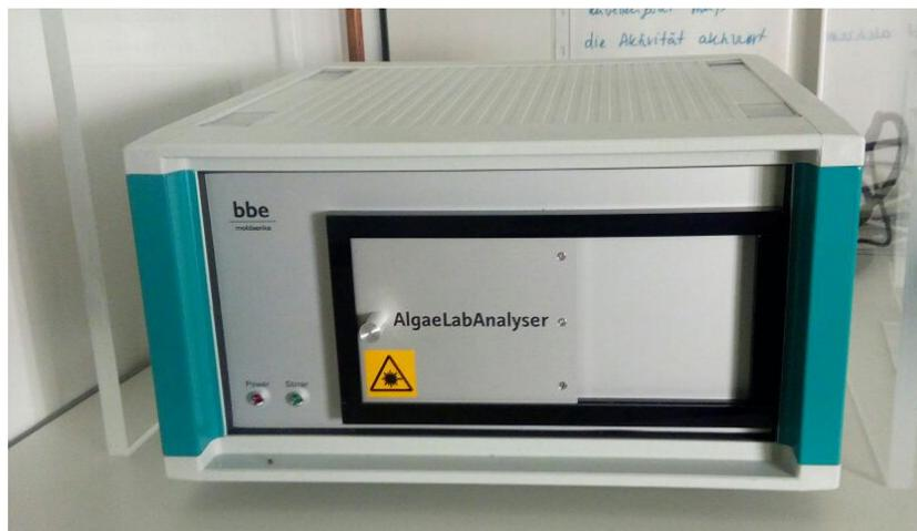
Abbildung 4: Das Küvetten-Fluorometer der Firma bbe moldaenke am Arbeitsplatz
