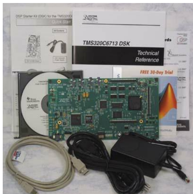
Abb. 5.1: Das komplette Starter-Kit (DSK) für den TMS320C6713 DSP
