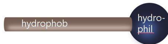
Abb. 1: Aufbau eines Tensidmoleküls [1]
