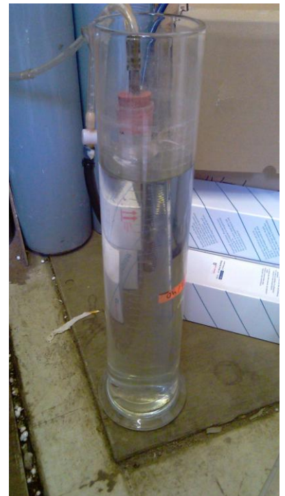
Grafik 4a.7: Bild der Messvorrichtung, um die Menge Gas (am Gasauslass) zu ermitteln, die durch den Mikro-GC strömt. Sie ist eine Gasglocke mit Schlauchanschluss in einem mit Wasser gefüllten Glaszylinder.
