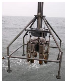
Abbildung 9 Probennahme Gerät Multi Corer (©R. Velten)
