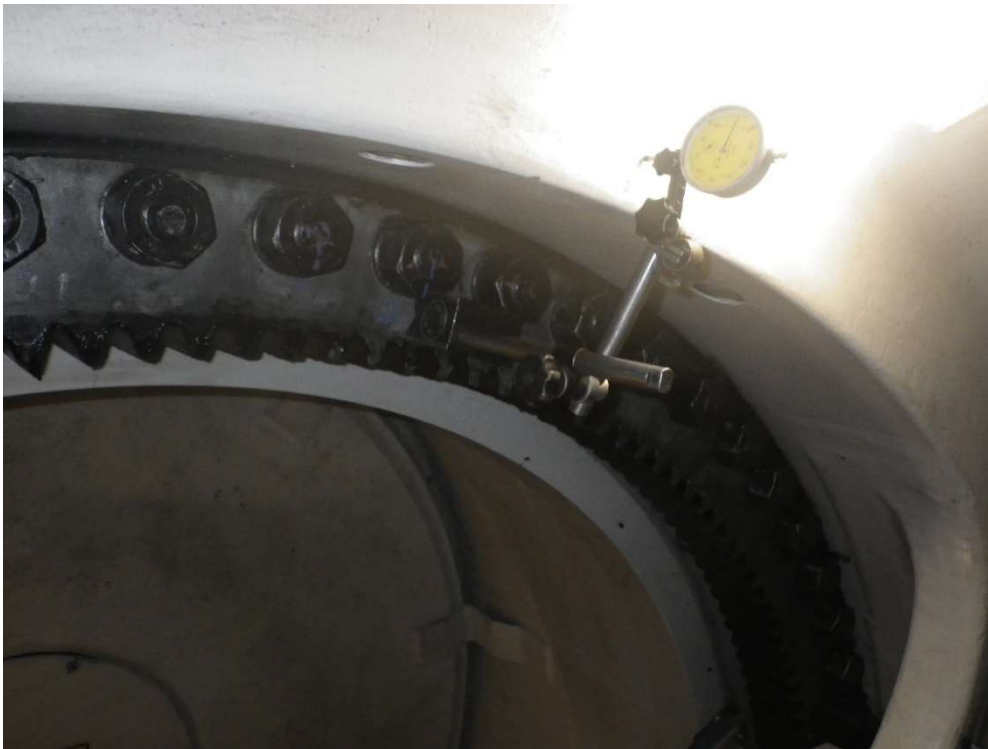
Abbildung 17: Messaufbau für Kippspielmessung in Rotornabe, Quelle: eigene Aufnahme
