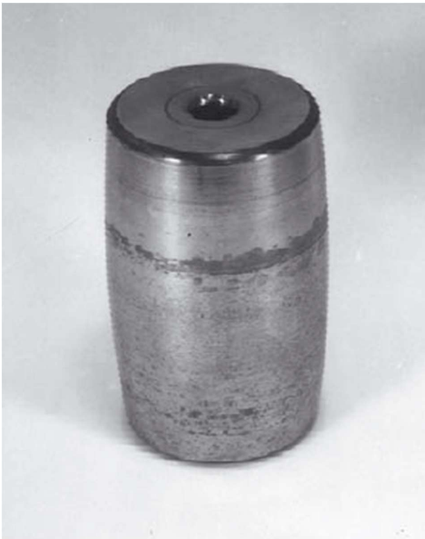
Abbildung 4: Oberflächenzerrüttung, die als Band über den gesamten Umfang einer Rolle eines Pendelrollenlagers verläuft, Quelle: SKF Gruppe, 2008
