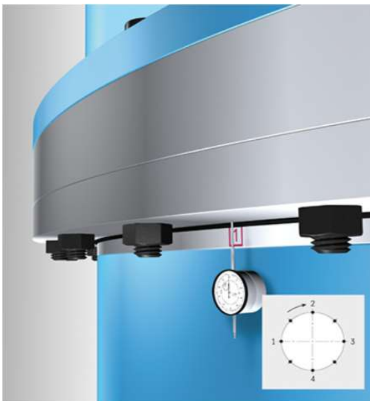
Abbildung 13: Prinzipieller Aufbau Kippspielmessung, Quelle: Rothe Erde GmbH, 2012
