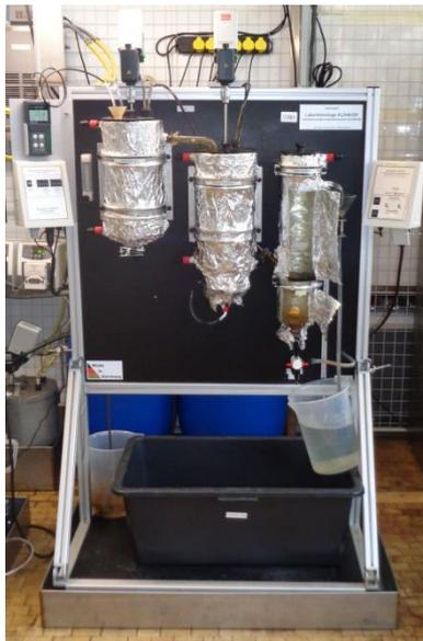
Abbildung 19: Abdeckung der Laborkläranlage mit Alu-Folie, mit Sichtfenstern in der Nachklärung (eigene Darstellung)
