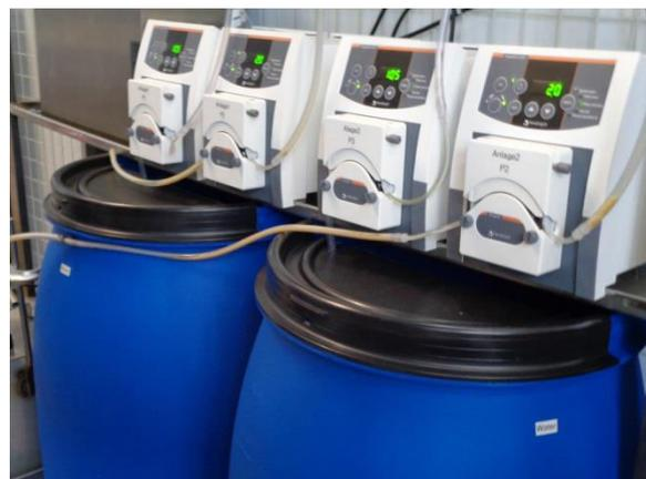
Abbildung 9: Zulaufpumpen "heidolph" für Nährstoff und Wasser
