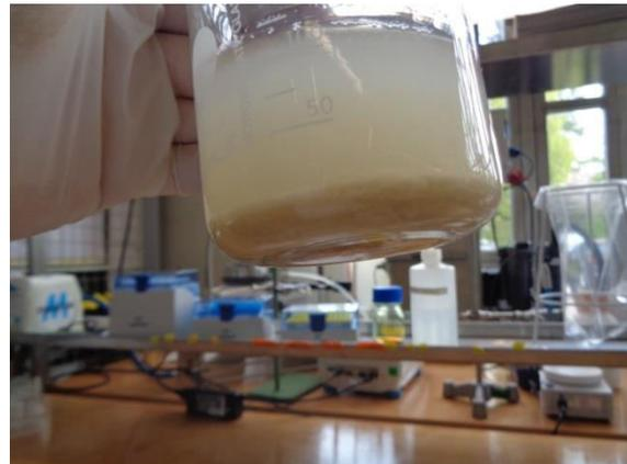
Abbildung 6: Ablagerungen der Nährstoff-Zulaufschläuche nach Spülung der Schläuche (eigene Darstellung)
