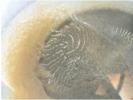
Abbildung 18: Schimmel-/Pilzsporen im Überlaufschlamm (eigene Darstellung)
