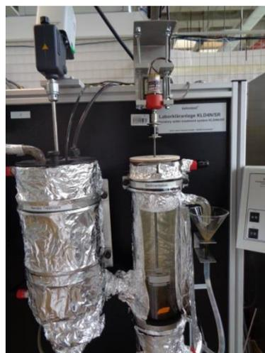
Abbildung 20: Rührung in der Nachklärung mit einem Gleichstrommotor für sehr geringe Umdrehungen (eigene Darstellung)
