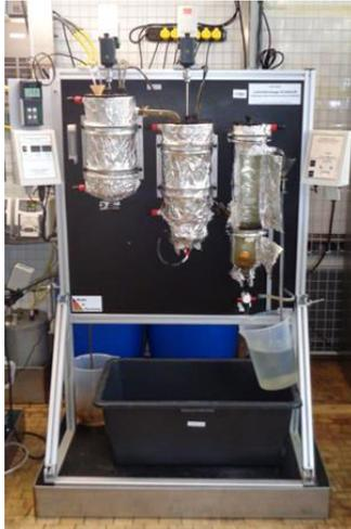
Abbildung 26: Endzustand der Laborkläranlage nach Umbau (eigene Darstellung)
