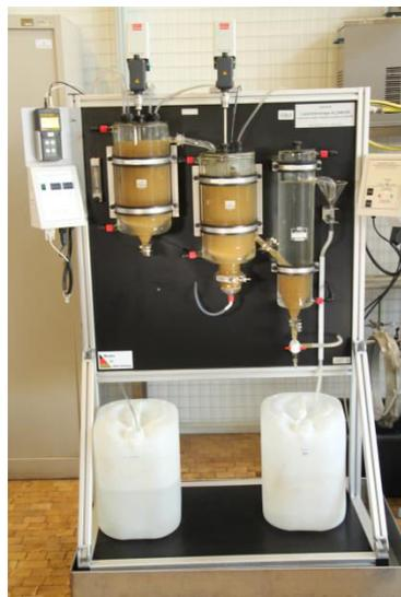
Abbildung 4: Verwendete Laborkläranlage (Scharff, 2017)
