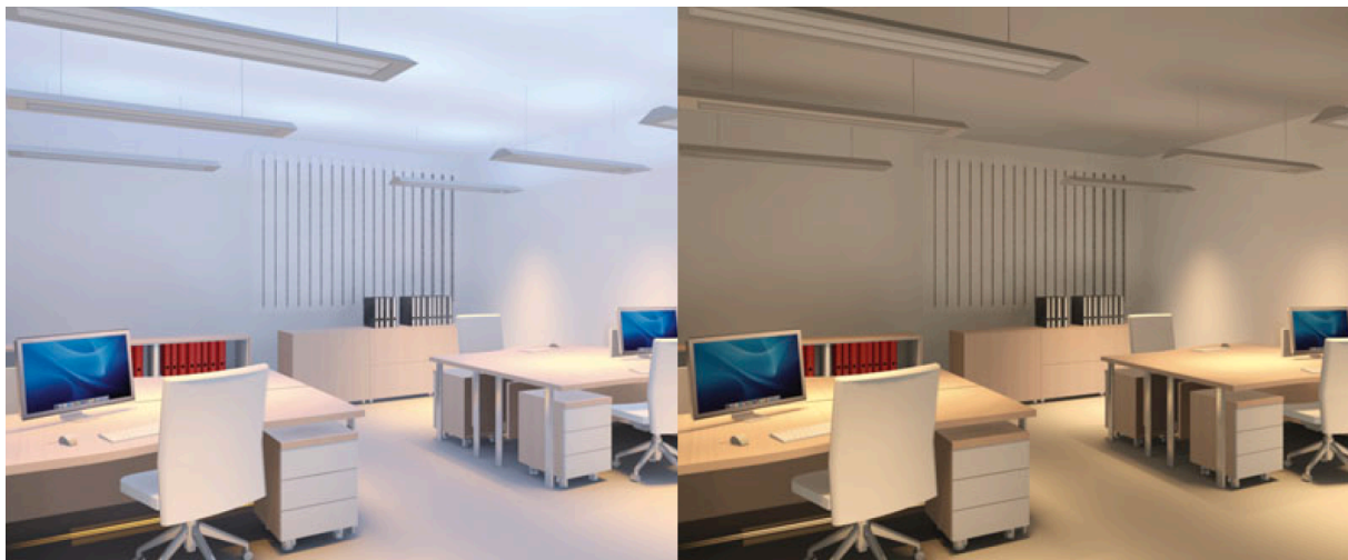
Abbildung 7: Unterschiedliche Beleuchtungsbedingungen im selben Büroraum: Höhere Beleuchtungsstärken, höhere Blauanteile und eine flächige Lichtverteilung am Morgen und mittags für eine melanopische Wirkung (links). Zum Feierabend möglichst geringe Blauanteile und gerichtetes Licht zur Vorbereitung des Körpers auf die Ruhephase (rechts). (Fördergemeinschaft Gutes Licht 2014: 30)
