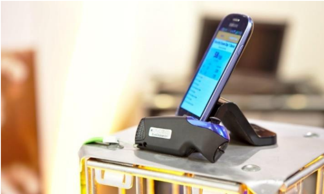
Abbildung 9 Digitaler Handklickzähler mit zugehöriger Software-Komponente 33
