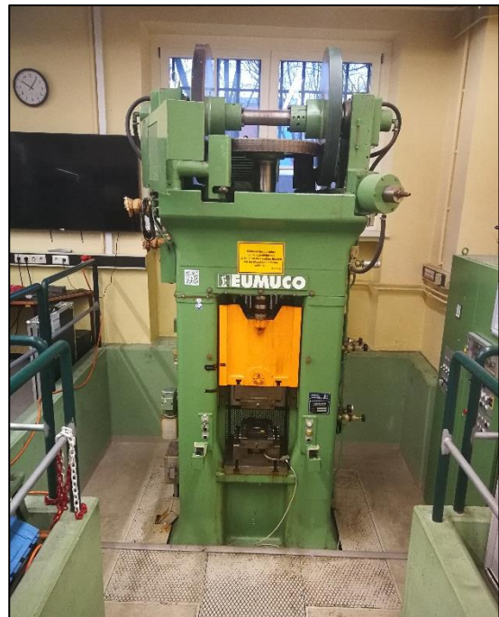
Abbildung 2 - Reibspindelpresse EUMUCO RSPP
