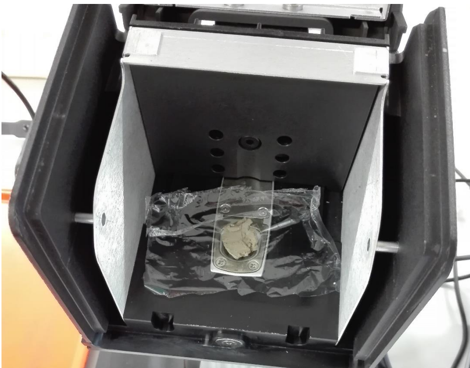
Abbildung 14 Bleikammer mit Folie und platzierter Probe (Foto: Samantha Warmuth)
