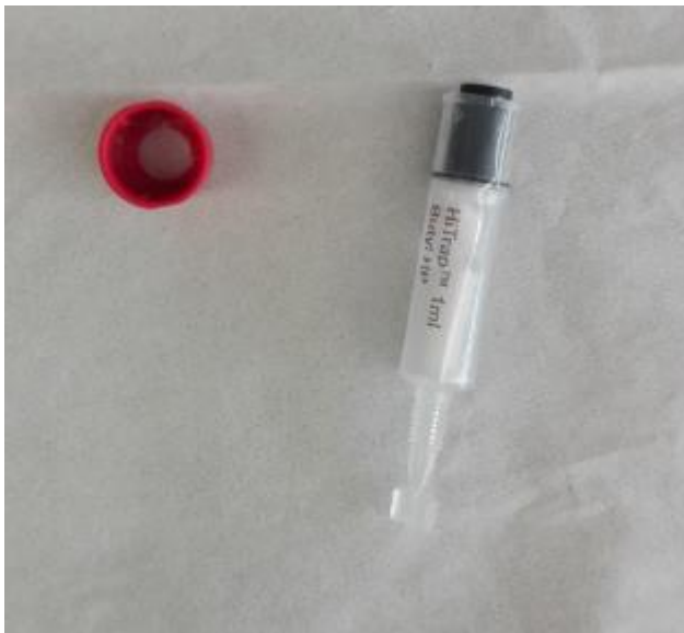
Abbildung 10: 1mL-Säule wird geöffnet um die Säule mit einem anderen Material zu befüllen
