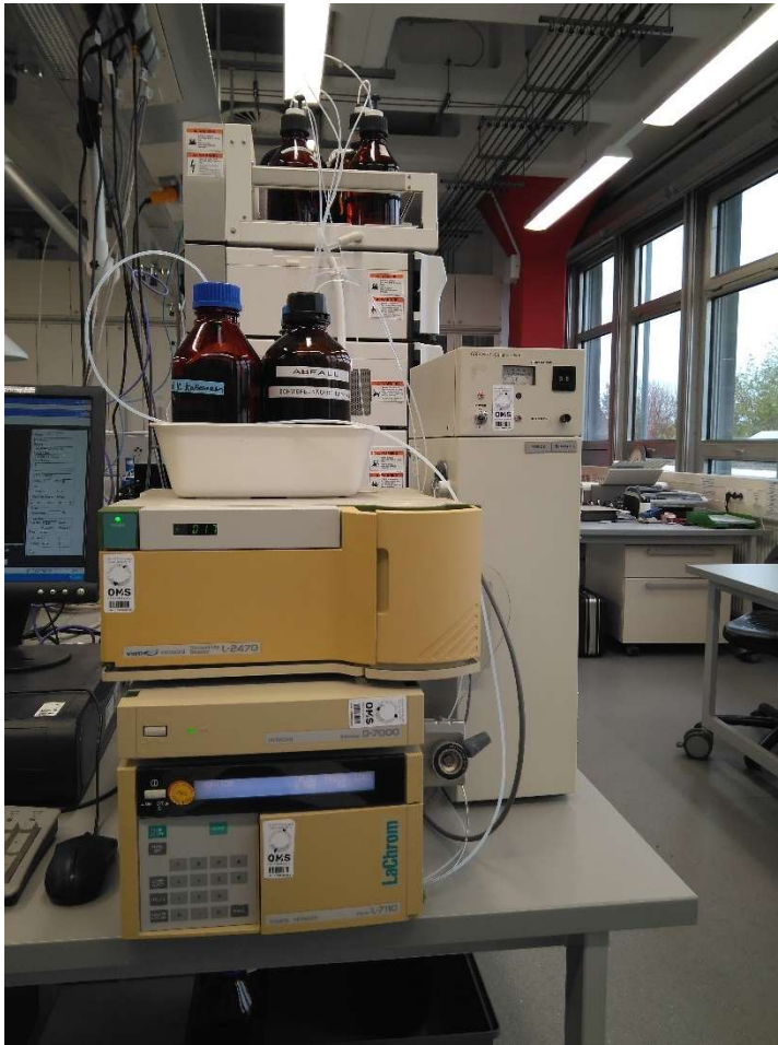
Abbildung 3: Merck Hitachi IC-Anlage. Ganz rechts befindet sich der Säulenofen, links davon befinden sich der Leitfähigkeitsdetektor, das Interface und die Pumpe (von oben nach unten).
