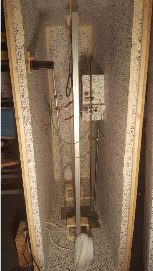
Abbildung 42: Versuchsaufbau – Temperaturkoeffizient Bestimmung
