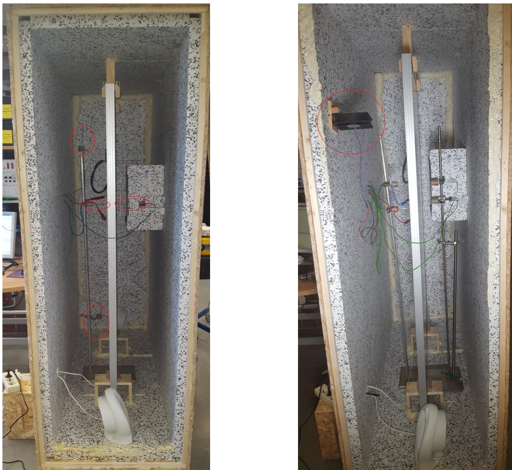
Abbildung 36: Homogenitätstest der Klima-Box (links) und der Versuchszelle (rechts)
