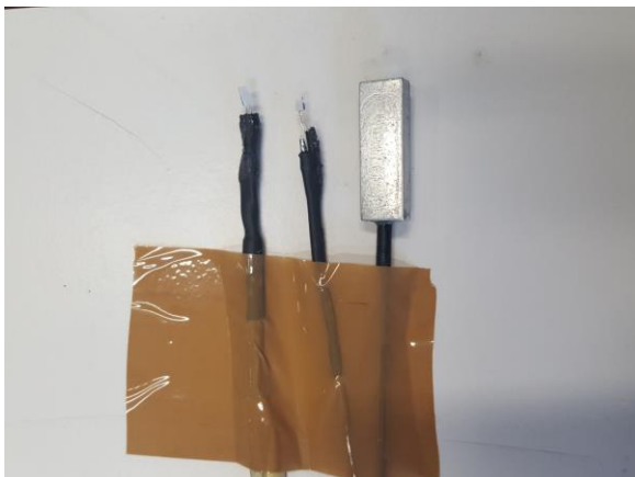
Abbildung 48: Temperatursensoren: Pt-1000 (links), Pt-100 (mitte) Pt-300N (rechts)
