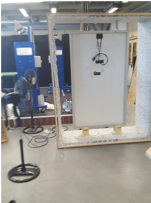
Abbildung 44: Geöffnete Klima-Box mit installiertem Modul
