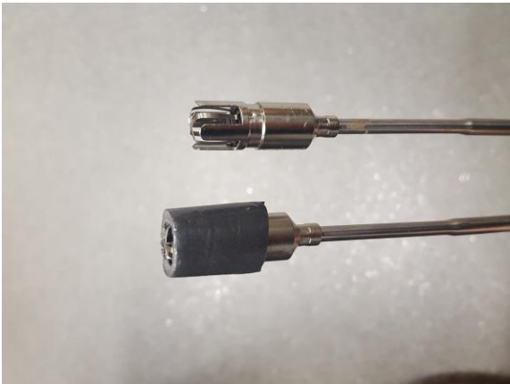
Abbildung 50: Isoliertes und nicht isoliertes Thermoelement
