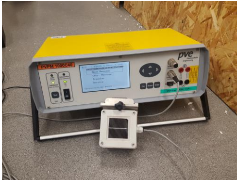
Abbildung 24: PVPM1000C [Pve, 2018] mit Einstrahlungssensor [NES, 2018]
