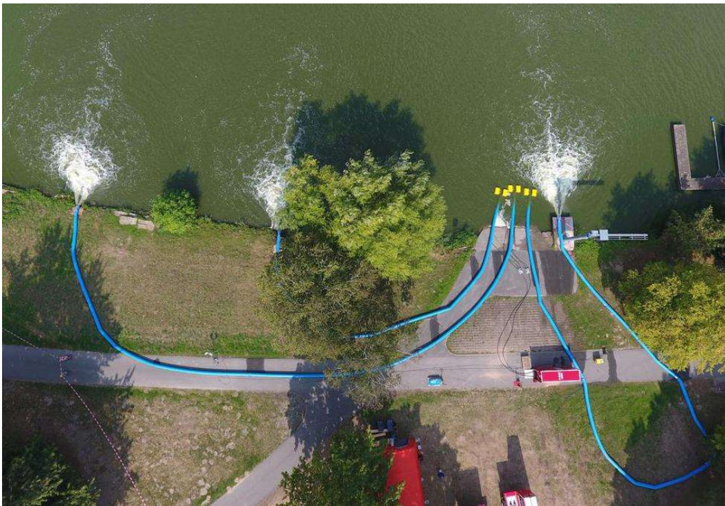
Abbildung 4: Oberflächenbelüftung durch Einbringen von Wasser durch die Feuerwehr im Aasee in Münster [aus 109]
