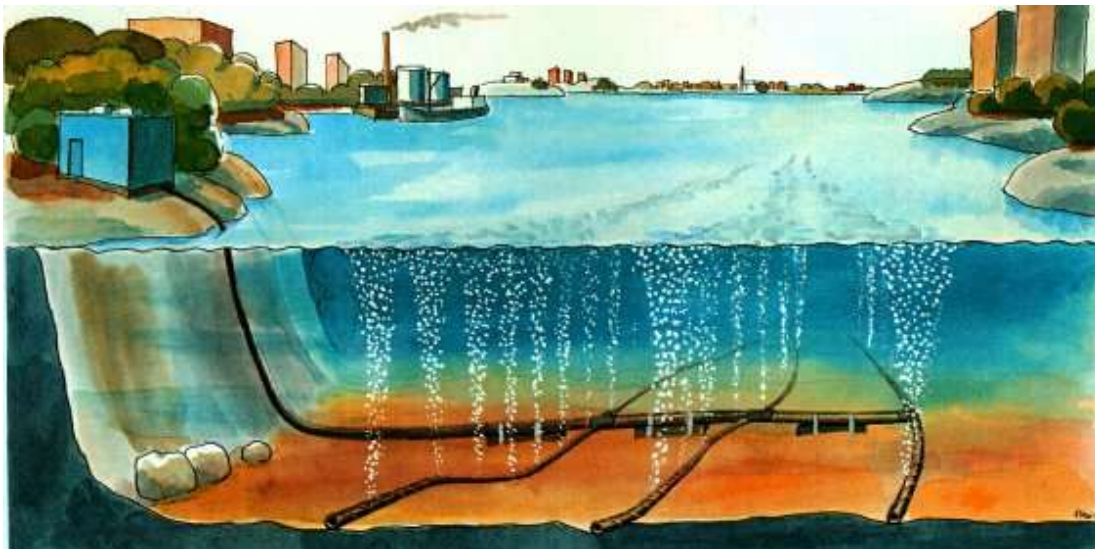
Abbildung 9: Funktionsweise Unterflächenbelüftung – Anreicherung mit Druckluft [aus 114]
