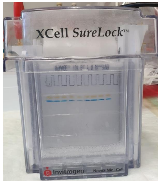
Abbildung 9: Darstellung einer laufenden SDS-PAGE- Gelelektrophorese mit einem 10%-igen Agarosegel. Betrieb bei 200 V für 37 min
