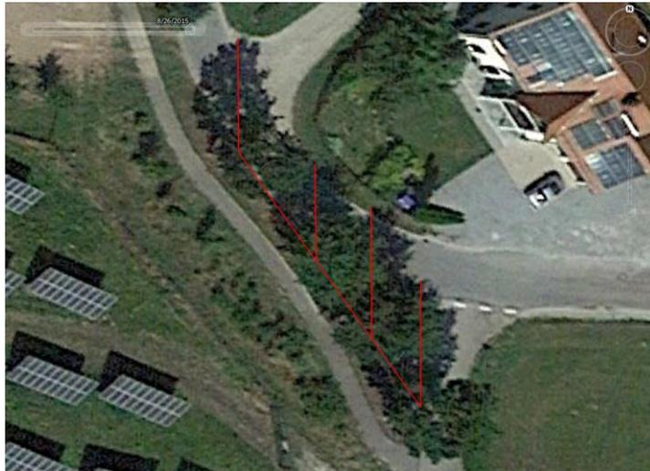
Abbildung 25: Messung der Schattenlängen der Bäume im Nordosten der PV-Anlage mit Hilfe von Google Earth Pro (2018)
