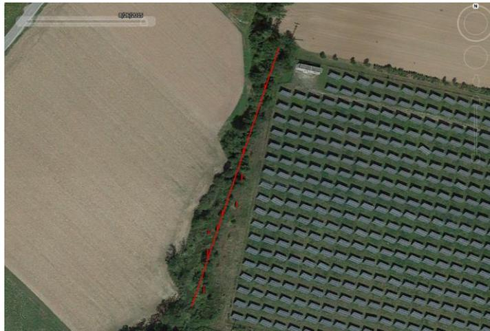
Abbildung 26: Messung der Schattenlängen der Büsche im Westen der PV-Anlage mit Hilfe von Google Earth Pro (2018)
