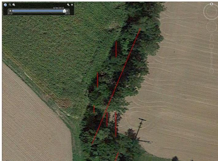
Abbildung 27: Messung der Schattenlängen der Büsche im Nordwesten der PV-Anlage mit Hilfe von Google Earth Pro (2018)
