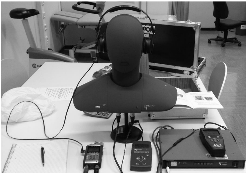
Bild 4.2: Methodik zur Prüfung und Dokumentation der Schalldruckpegel der akustischen Szenarien mit dem Kunstkopf, eigene Aufnahme
