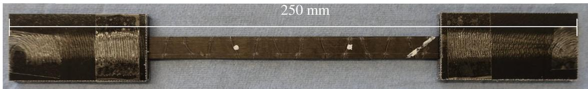
Abbildung 7.3: Krafteinleitungselemente an einer 0° Zugprobe
