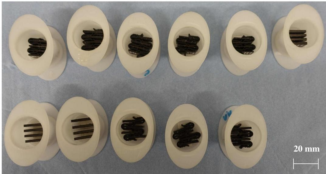
**Abbildung 5.15: Proben in Einbettformen**
