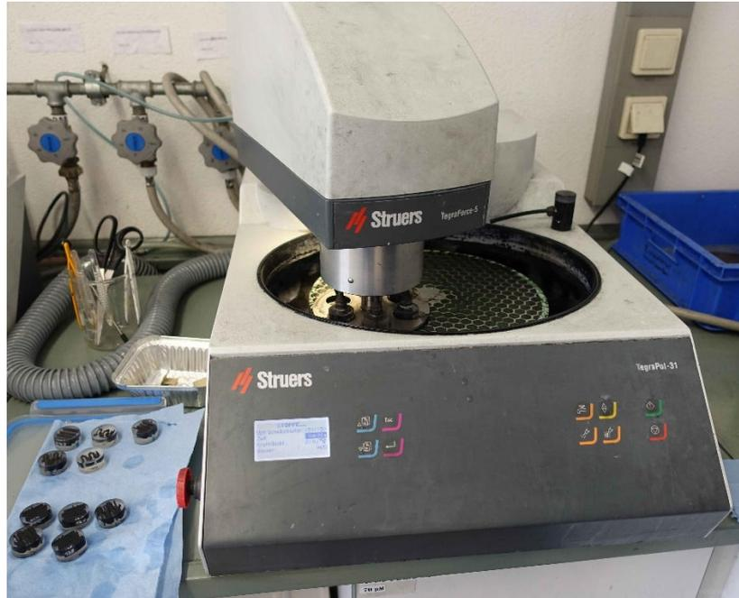
Abbildung 5.16: Schleifen der Schliffbildproben
