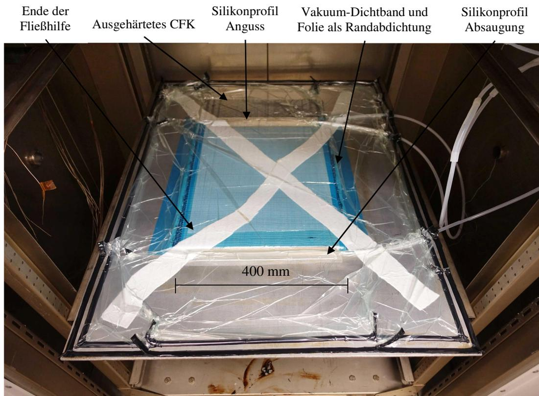
**Abbildung 5.12: Fertiger Infusionsaufbau Platte P6A**
