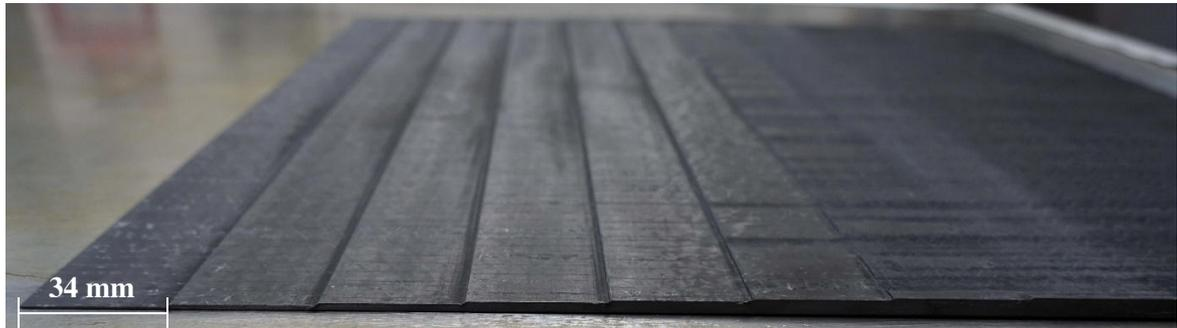
Abbildung 5.10: Gefräste Stufen an Platte P7
