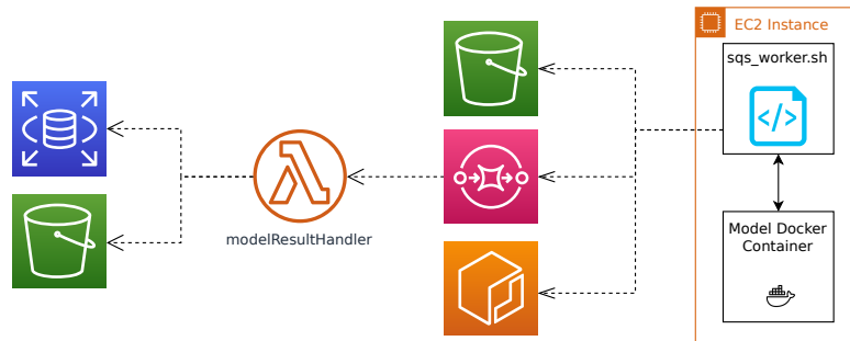
Abbildung 7.19: Der Docker Container wird innerhalb einer EC2 Instanz ausgeführt. Für die Ausführung des Containers und die Versorgung mit Daten ist ein Shell Skript zuständig.
