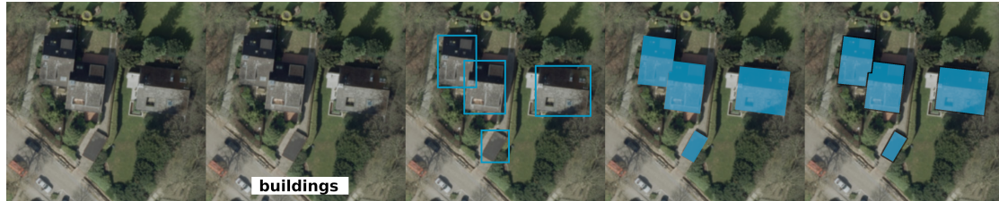
Abbildung 8.1: Aufgabenkategorien im Bereich der Computer Vision. Von links nach rechts: Eingabebild, Labeling, Image Detection, Image Segmentation, Instance Segmentation
