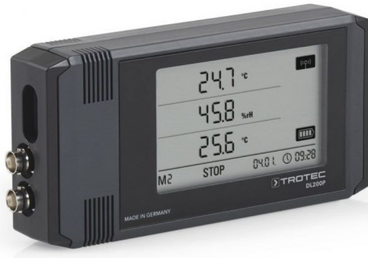
Abbildung 5.2.: Der für den Temperaturvergleich verwendete Datenlogger
