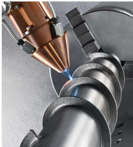
Abbildung 7: Darstellung einer DMD-Anlage beim Auftragen einer Kontur auf ein Werkstück
