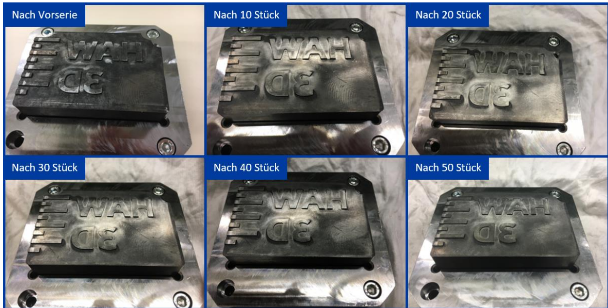
Abbildung 18: Veränderung des gefrästen Stempels über 50 Werkstücke
