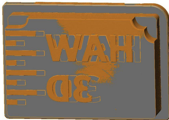
Abbildung 19: Darstellung der Verschiebung der Gravur des gefrästen Stapels
