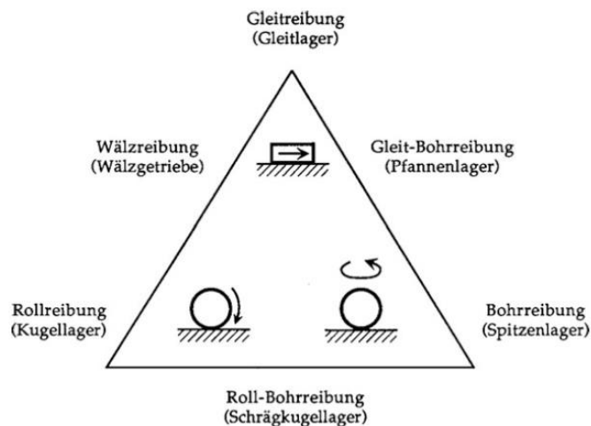
Abbildung 4.2: Einteilung der Reibungsarten nach der Kinematik („Reibungsdreieck“) [9]
